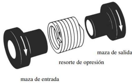
**Figura 7 – 2.** Embrague de contacto positivo
