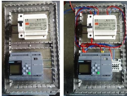
**Figura 67 – 3.** Montaje de elementos
