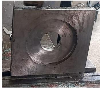
**Figura 63 – 3.** Corte y perforado de placa
