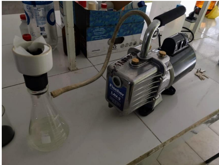
Figura 3C. Proceso de filtración
