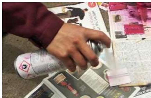
**Figura 26-3:** Revelador aplicado sobre las juntas
