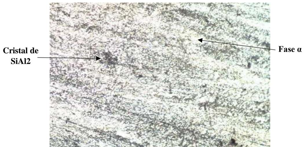
**Figura 49- 3:** Microestructura junta soldada N°5 aumento 100x
