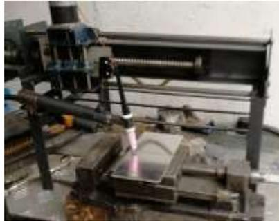
**Figura 2-3:** Antorcha GTAW montada en el equipo de control de velocidad de avance
