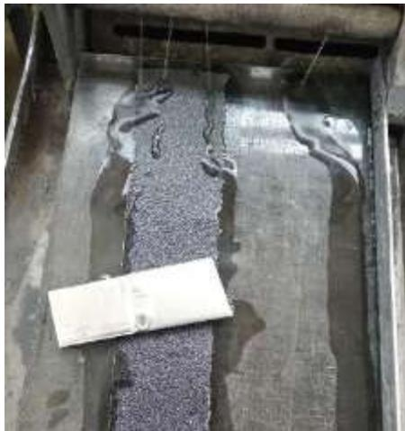
**Figura 32:** Desbaste de la superficie a analizar
