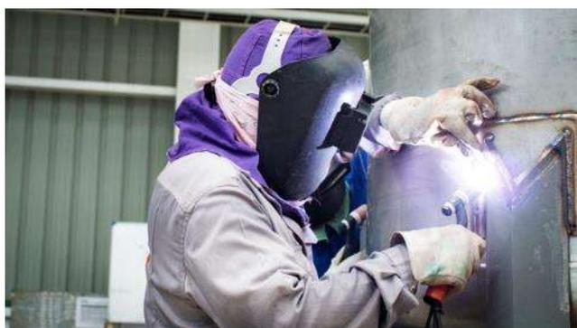
**Figura 6-2:** Arco eléctrico proceso GTAW gas de protección Argón
