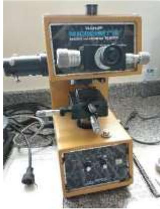
**Figura 33-3:** Micrómetro para ensayo de dureza Vickers
