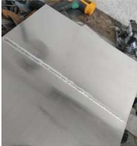
**Figura 19-3:** Junta de aluminio soldada
