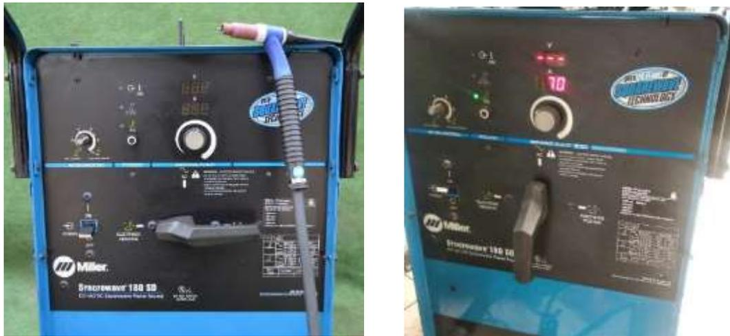
**Figura 3-3:** Equipo de alta frecuencia para soldadura GTAW
