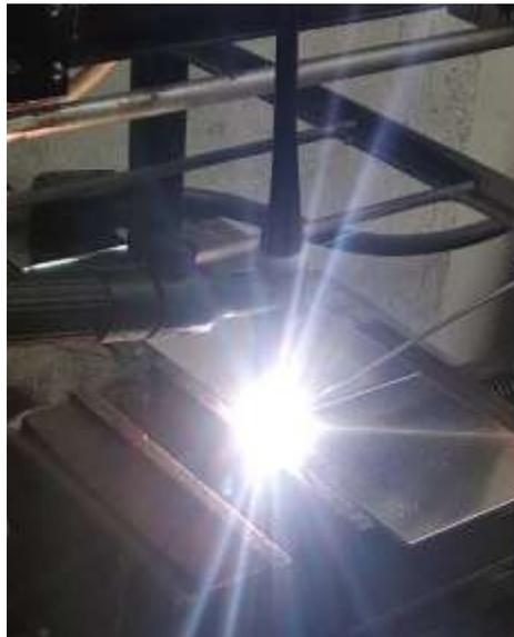
**Figura 16-3:** Montaje de las placas a soldar
