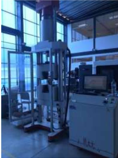
**Figura 36-3:** Equipo utilizado para ensayos de tracción
