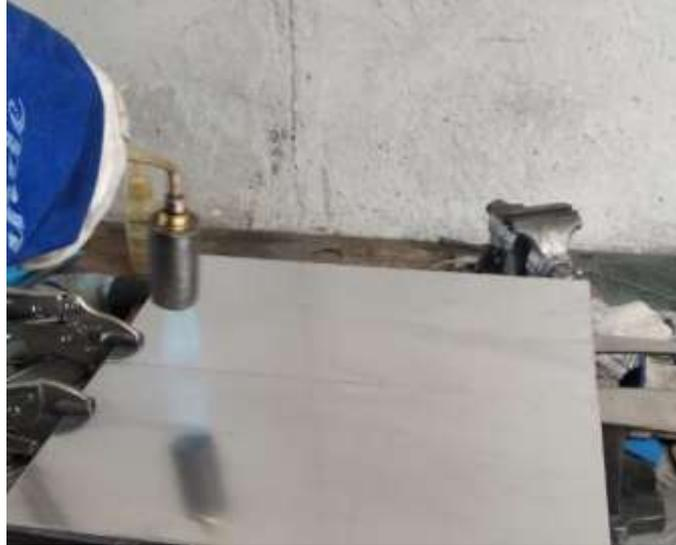
**Figura 15-3:** Pre calentamiento de las juntas para soldar
