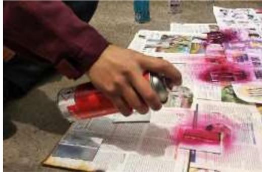
**Figura 24-3:** Aplicación del líquido penetrante Karl Deutsch
