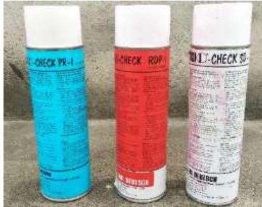
**Figura 22-3:** Líquidos Penetrantes Karl Deutsch para ensayos no Destructivos
