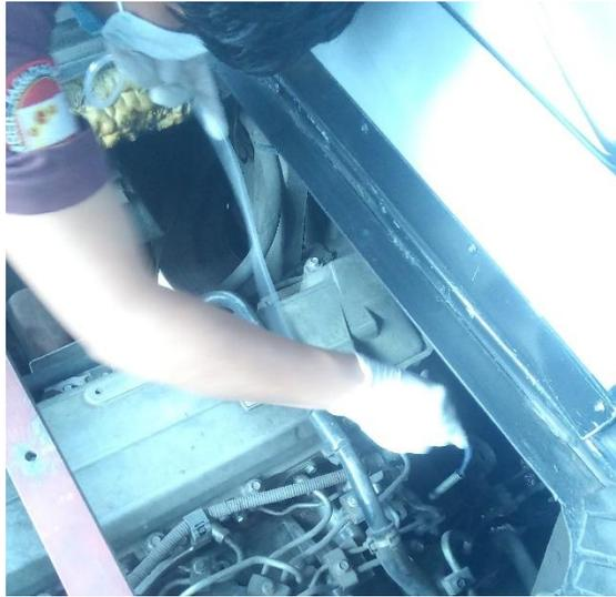
**Figura 18-2.** Manguera introducida a través de la varilla indicadora de nivel
