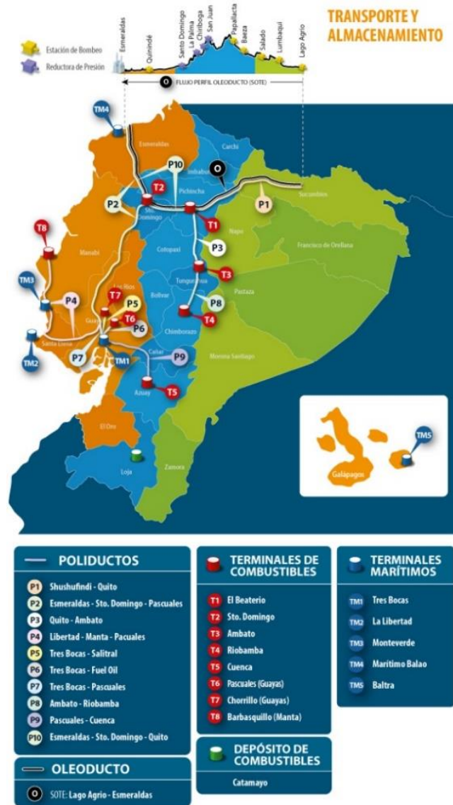
Figura 8-1: Diagrama de la red de poliductos en Ecuador
