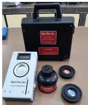
**Figura 1-2.** Sistema de medición de radón E-PERM.
