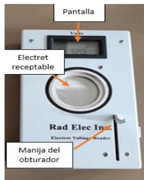
**Figura 5-2.** Lector voltaje para Electrets, modelo SPER-1E.
