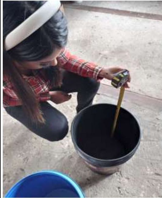
Medición del espesor de las capas del Filtro
