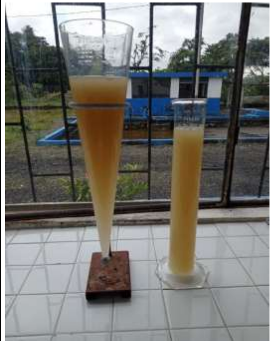
Prueba de Sedimentación de las aguas Miel
