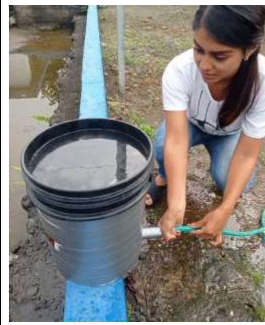
Retrolavado del filtro
