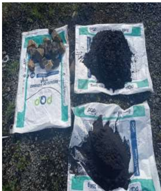
Lavado de los materiales del lecho filtrante
