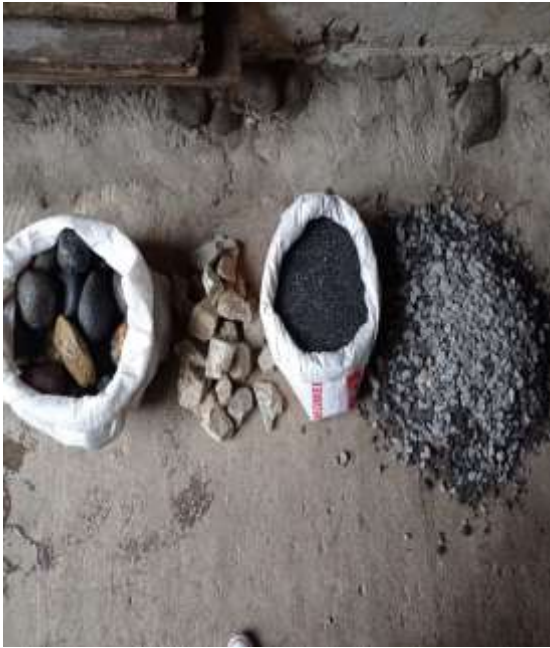
Materiales del Lecho Filtrante
