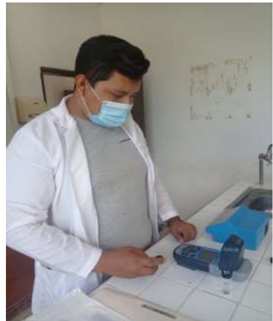
Determinación de nitratos, fosfatos y turbidez mediante el fotómetro
