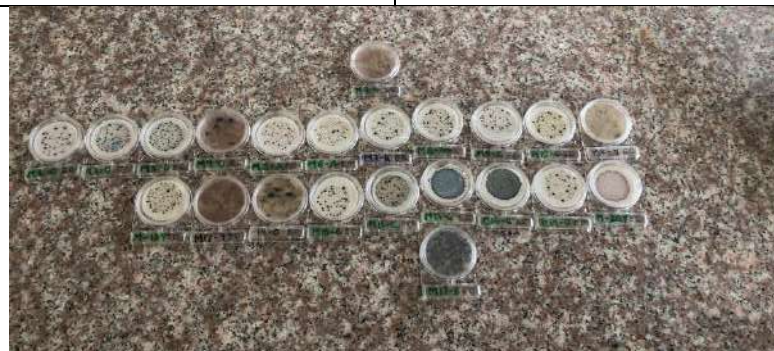
Siembra de coliformes totales - Laboratorio de Calidad del Agua ESPOCH
