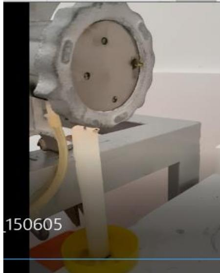
**ANEXO D:** EXTRACCIÓN DEL ACEITE DE SAMBO SEGÚN POR Prensado en Frío.
