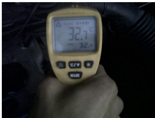
Figura 3.7 Medición de Temperatura de Aire Motor 4ZD1 Atmosférico
