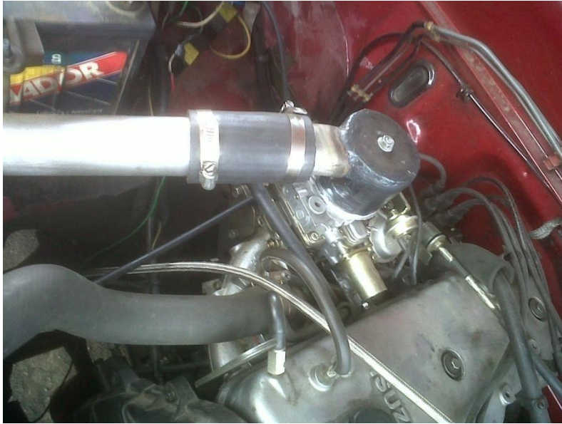
Figura 4.10 Sistema de Admisión de un Motor Turbo Alimentado
