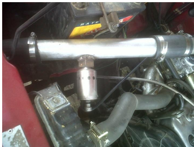
Figura 4.11 Válvula Blow Off Tipo Push Type
