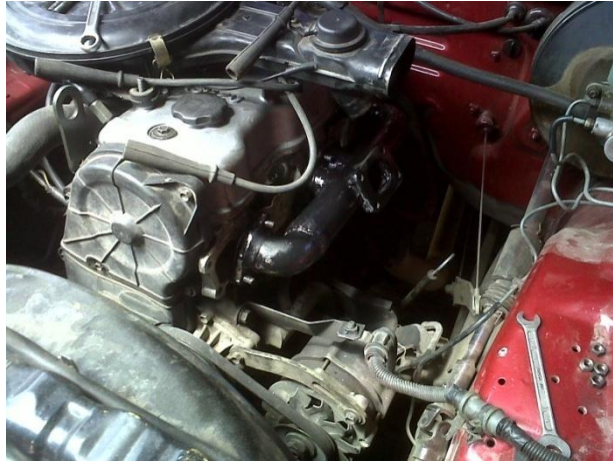
Figura 4.13 Múltiple de Escape para el Motor 4ZD1 Turbo Alimentado
