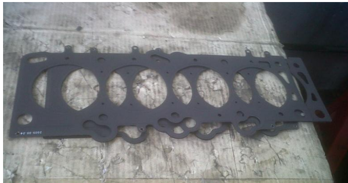
Figura 4.9 Empaque de Cabezote Motor 4ZD1
