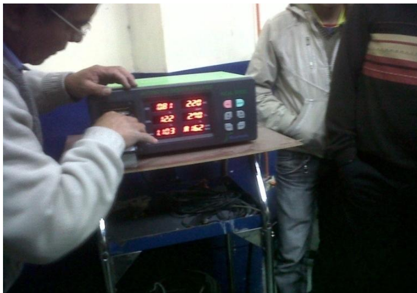
Figura 3.8 Medición de Gases de Escape Motor 4ZD1 Atmosférico
