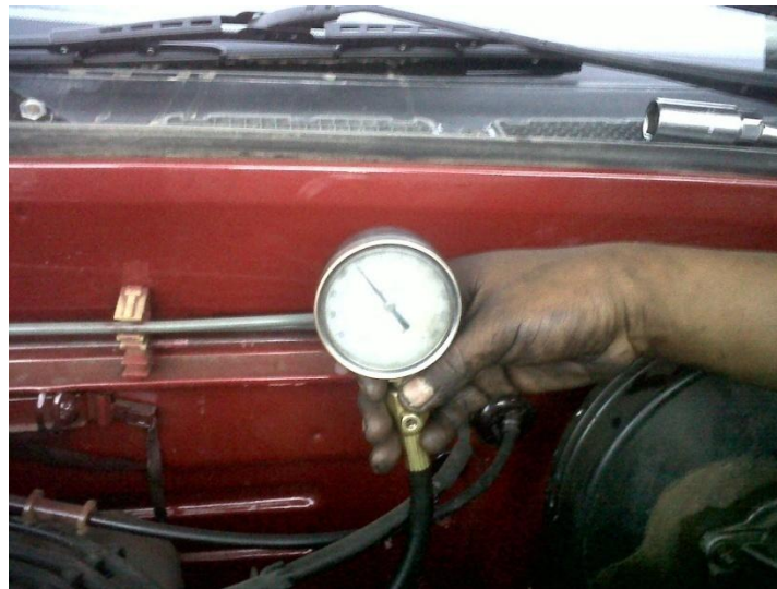
Figura 3.6 Medición de la Compresión Motor 4ZD1 Atmosférico
