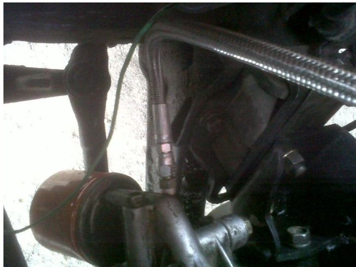
Figura 4.17 Tom a de Lubricación para el Turbocom presor
