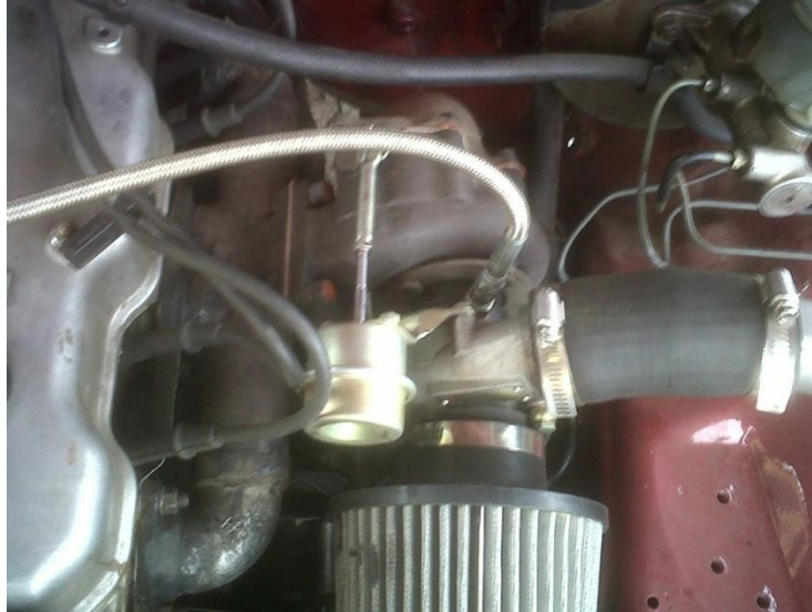
Figura 4.15 Válvula W astegate del Turbocompresor Garrett GT2252
