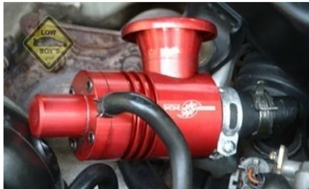
Figura 4.12 Válvula Blow Off tipo Pull Type
