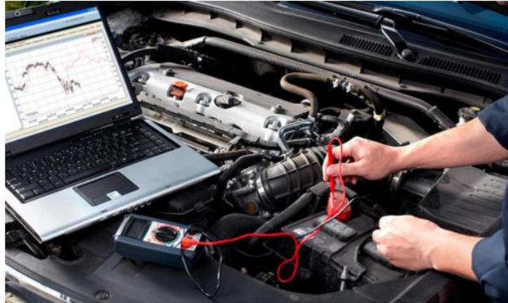
**Figura 10-4:** Medición de un actuador
