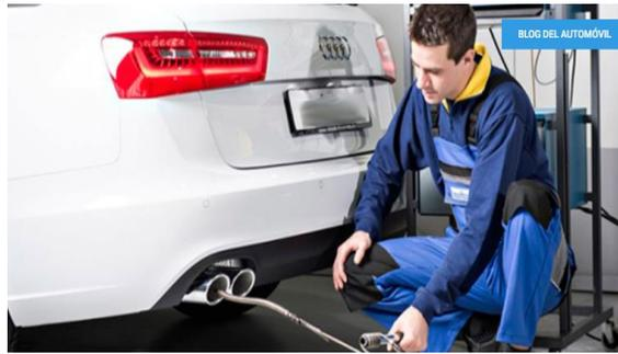
**Figura 7-4:** Uso del analizador de gases
