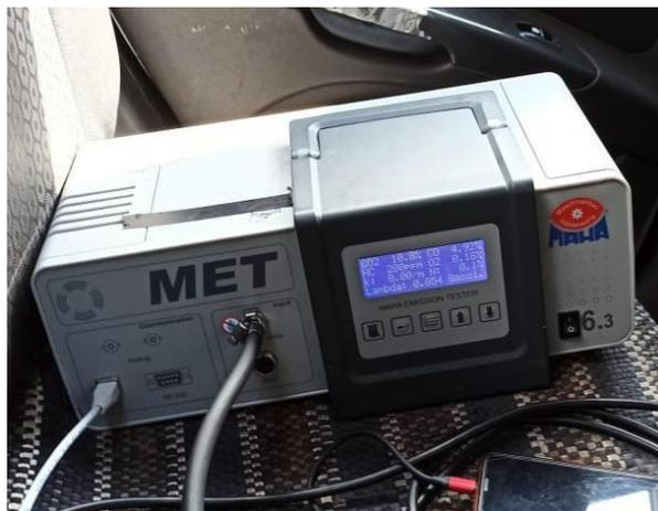
**Figura 2-1:** Analizador de gases MAHA MET 6.3
