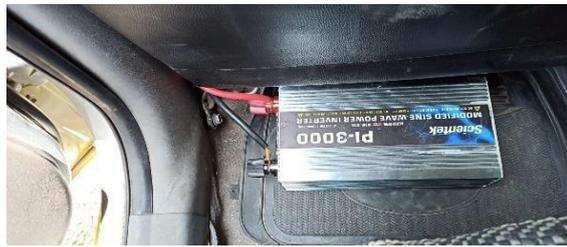
**Figura 12-2:** Instalación del inversor de voltaje
