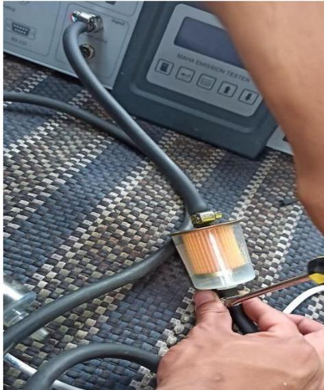
**Figura 16-2:** Instalación del filtro a la entrada de la sonda
