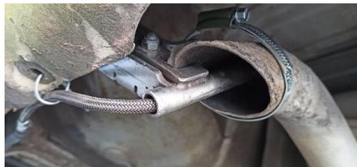
**Figura 15-2:** Instalación de la sonda en el tubo de escape
