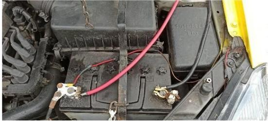
**Figura 11-2:** Conexión del inversor a la batería
