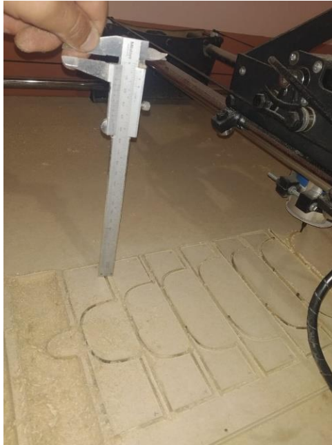
Figura 85-4. Verificación de la tolerancia de corte Fuente: (Autor)
