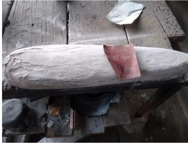
Figura 91-4. Masillado y lijado Fuente: (Autor)
