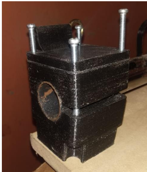
Figura 51-3. Acople de los sujetadores esquineros
