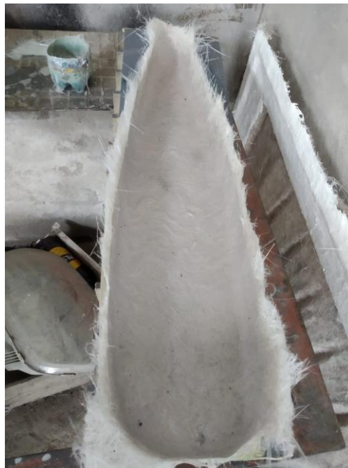
Figura 90-4. Colocación de la fibra de vidrio Fuente: (Autor)
