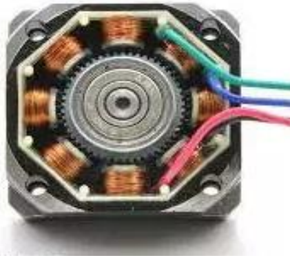
Figura 8-2. Motor paso a paso Fuente: (Ingeniería Mecafenix 2017)
