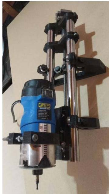
Figura 63-3. Montaje del Router Fuente: (Autor)
