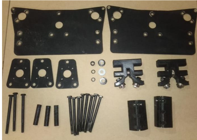
Figura 52-3. Elementos de los parantes Fuente: (Autor)
