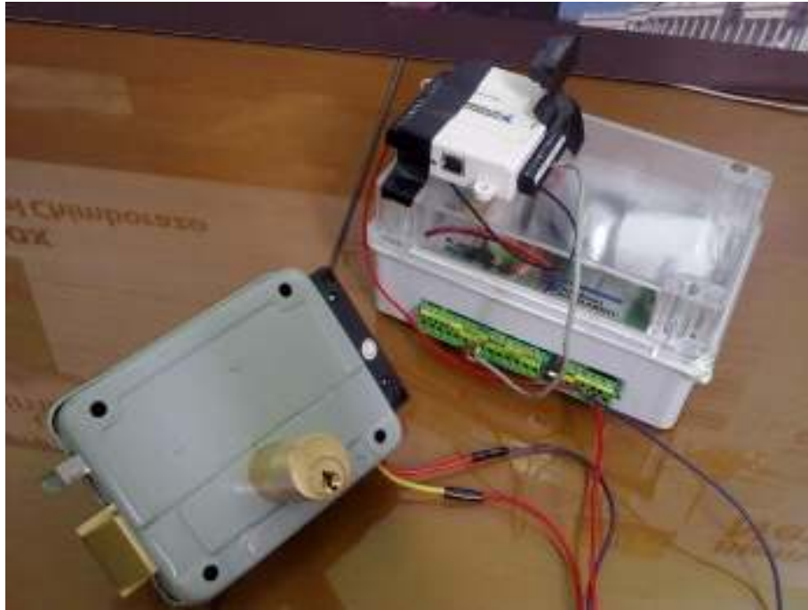
Figura IV.24: Conexión de la DAQ al EPC
