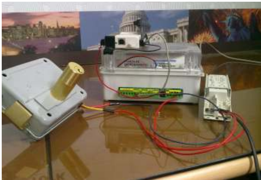
Figura IV.25: Conexión del transformador y la Cahapa al EPC
