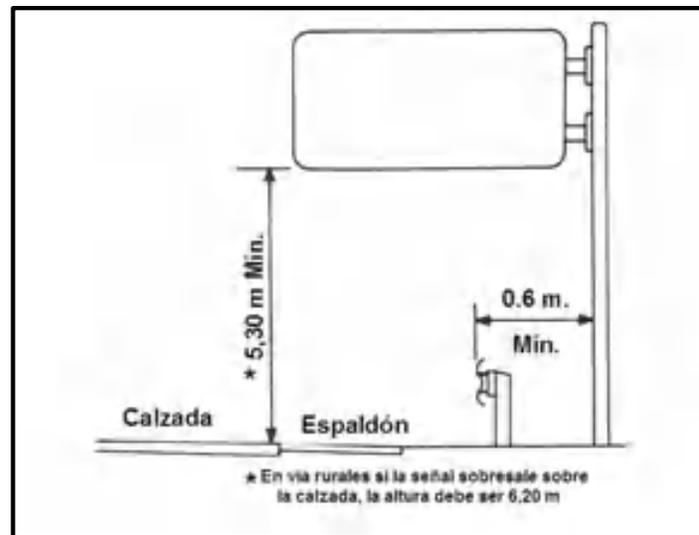
**Figura 1-1:** Estructura típica para señales elevadas
