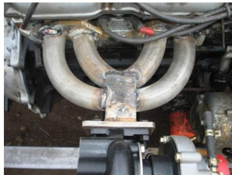
**Figura 5.34 Nuevo múltiple de escape con la base para el turbocompresor**
