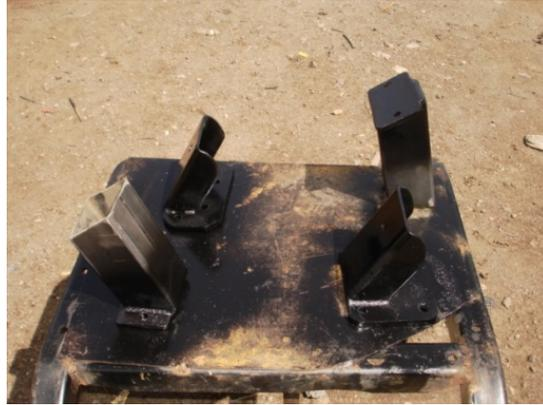
**Figura 5.2 Bases del motor y de la caja de velocidades**
