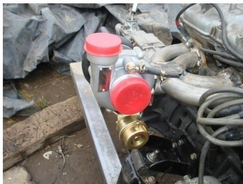
**Figura 5.35 Montaje del turbocompresor al múltiple de escape**
