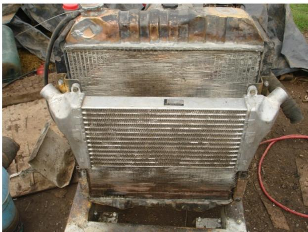
**Figura 5.18 Disposición y anclaje del radiador al bastidor**
