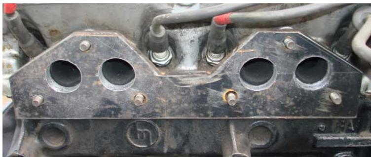
**Figura 5.32 Platina ubicada en el motor con 4 perforaciones de diámetro 4 cm**
