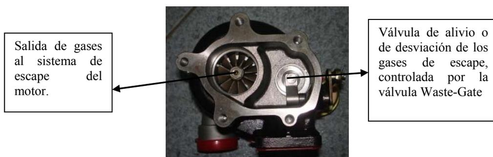
**Figura 5.38 Entradas y salidas del turbocompresor**
