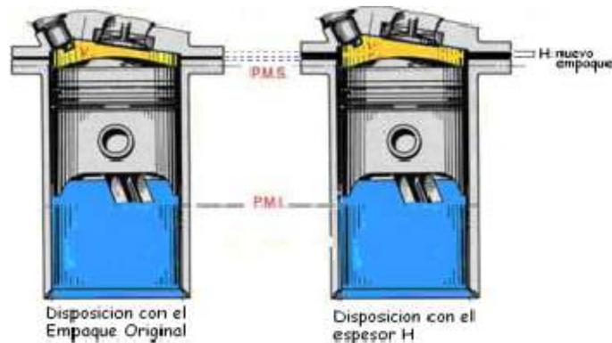
**Figura 5.8 Variación del volumen de la cámara de combustión.**
