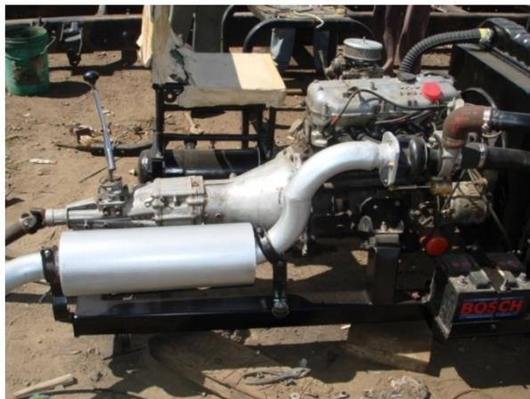
**Figura 5.42 Sistema de escape del motor sobrealimentado**
