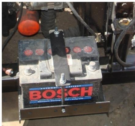
**Figura 5.29 Disposición de la base de la batería con respecto al bastidor**
