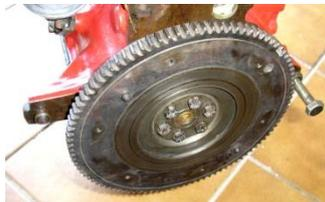
**Figura 2.14 Volante de inercia**
