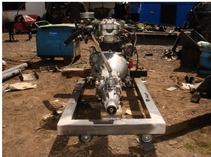
**Figura 5.6 Cuatro ruedas montadas y soldadas al bastidor**
