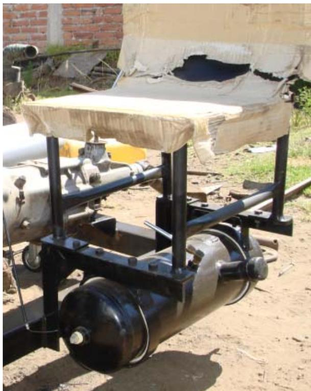
**Figura 5.25 Disposición del sillón y el tanque de combustible en el bastidor**
