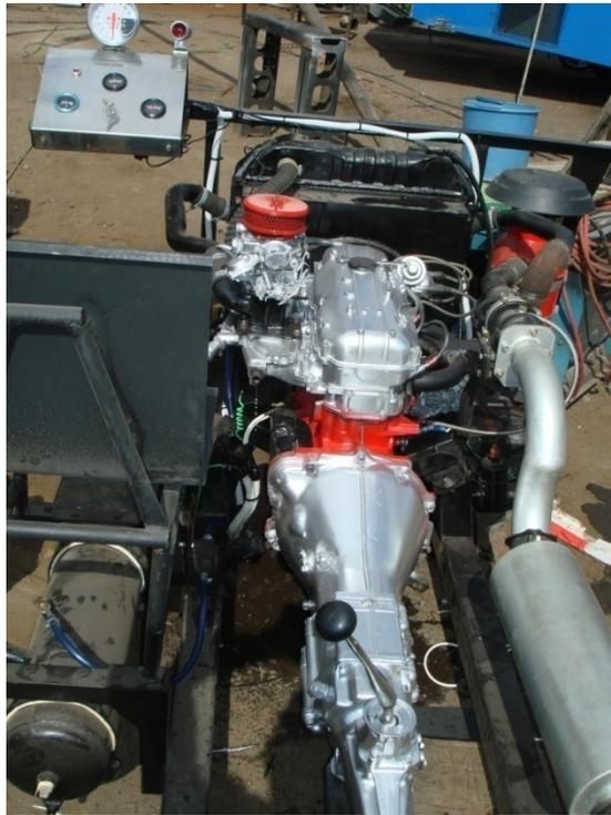
**Figura 5.51 Motor estacionario sobre alimentado ya concluido.**
