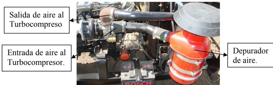
**Figura 5.43 Unión del turbocompresor con el depurador de aire y el intercooler**
