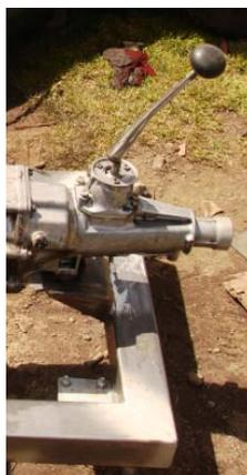
**Figura 5.4 Base de la caja de velocidades soldada al bastidor**
