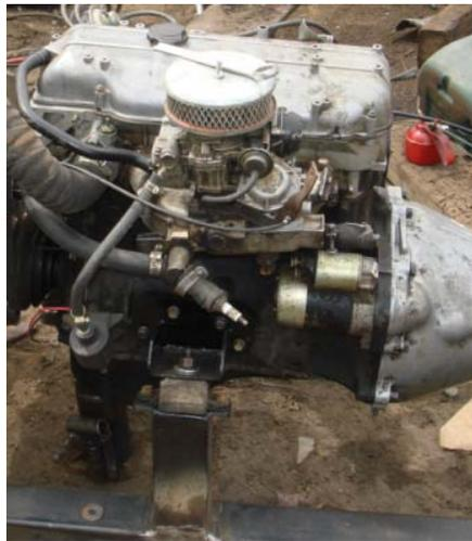
**Figura 5.3 Base del motor soldada al bastidor**
