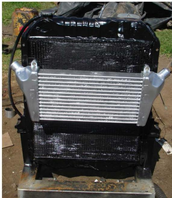
**Figura 5.20 Disposición del intercambiador respecto al radiador del motor**
