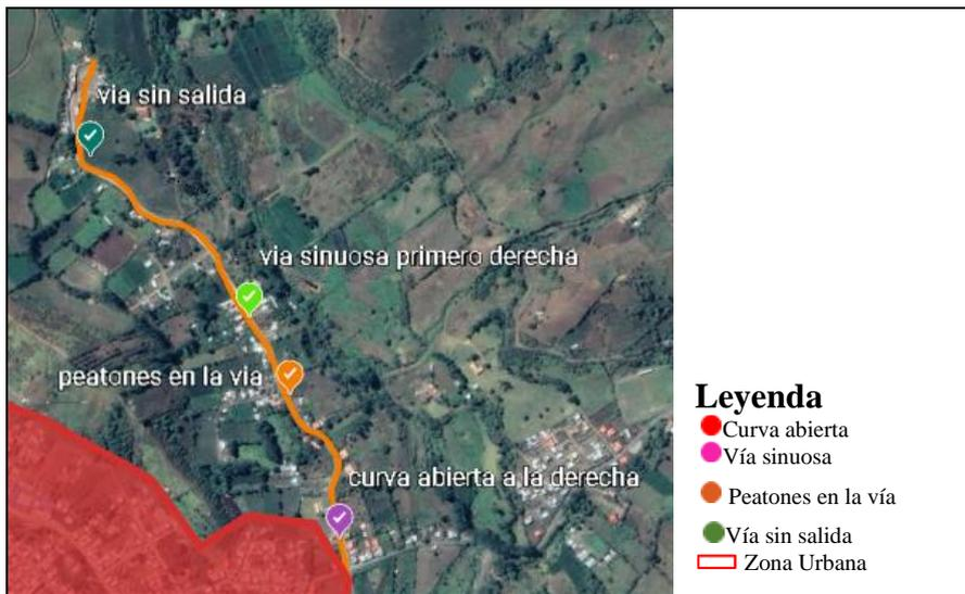
**Figura 26-3:** Propuesta de Señalización Vertical en la Vía 5
