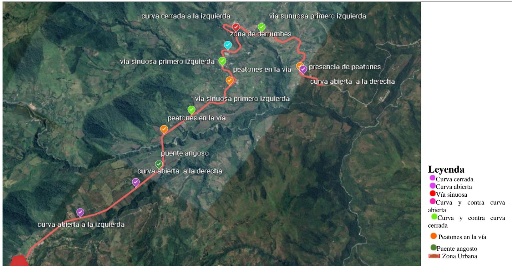
**Figura 24-3:** Propuesta de Señalización Vertical en la Vía 3
