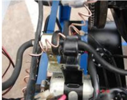
**Figura 4.40** Válvula del canister
