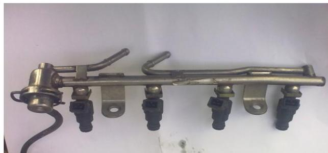
**Figura 2.16** Distribuidor de combustible
