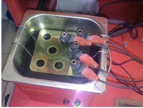
**Figura 4.36** Limpieza de inyectores por ultrasonido
