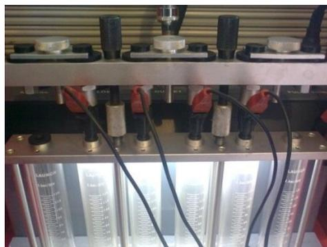
**Figura 4.29** Probetas y riel del limpiador TEST LAUNCH
