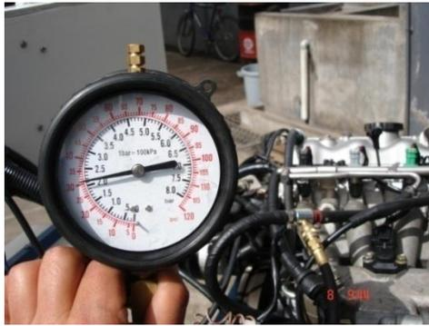
**Figura 4.4** Prueba de la presión de combustible
