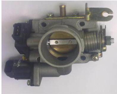
**Figura 2.36** Válvula de estrangulador
