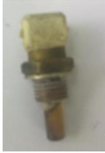
**Figura 2.3** Sensor de temperatura del líquido refrigerante (ECT)
