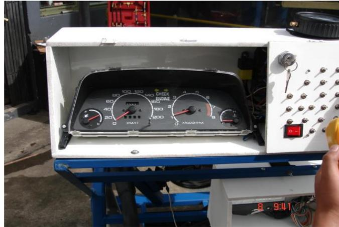
Figura 3.55 Panel de instrumentos
