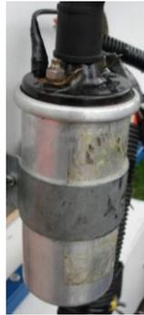
**Figura 2.18** Bobina de ignición
