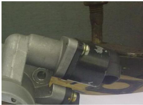
**Figura 2.10** Válvula de control de aire (IAC)
