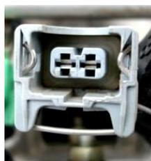
**Figura 3.35** Conector del inyector
