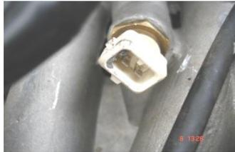
**Figura 3.25** Sensor de temperatura
