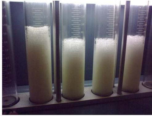
**Figura 4.34** Prueba del ángulo de pulverización
