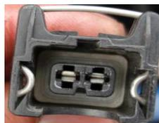
**Figura 3.44** Conector de la purga del Canister
