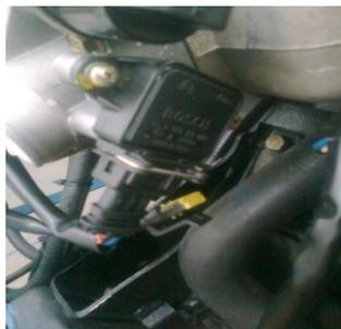
**Figura 2.4** Sensor de posición de la válvula de aceleración
