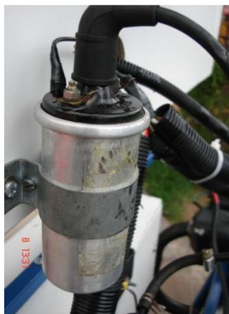
**Figura 3.46** Bobina de encendido
