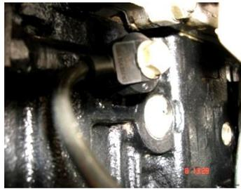
**Figura 3.23** Sensor de detonación
