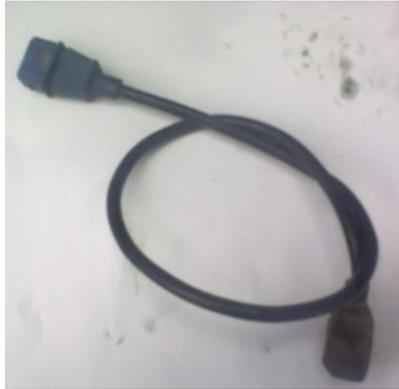
**Figura 2.7** Sensor de detonación
