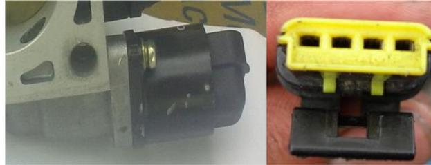
**Figura 4.38** Conector del sensor IAC
