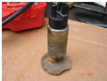
**Figura 4.3** Bomba de combustible (parte externa)
