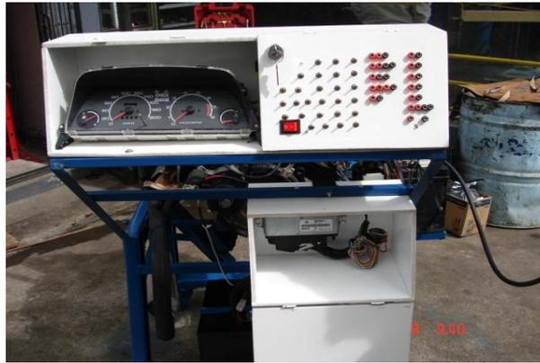
**Figura 3.16** Disposición del tablero de instrumentos
