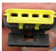
**Figura 3.38** Conector de la válvula IAC
