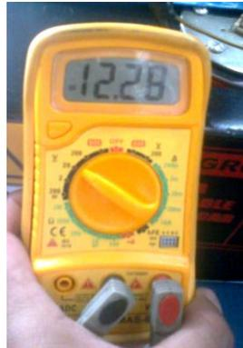
**Figura 4.5** Prueba del voltaje de alimentación
