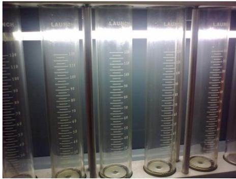
Figura 4.37 Prueba de goteo
