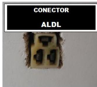
**Figura 3.53** Conector de enlace de datos
