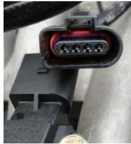
**Figura 4.7** Conector del sensor MAP
