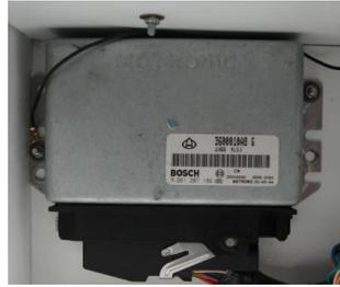
**Figura 2.1** Módulo de control del motor (ECU)
