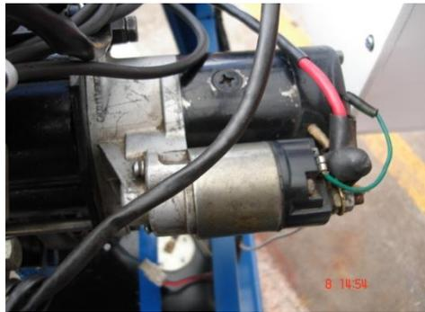
**Figura 3.51** Motor de arranque
