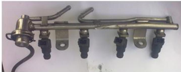
**Figura 4.26** Distribuidor del combustible
