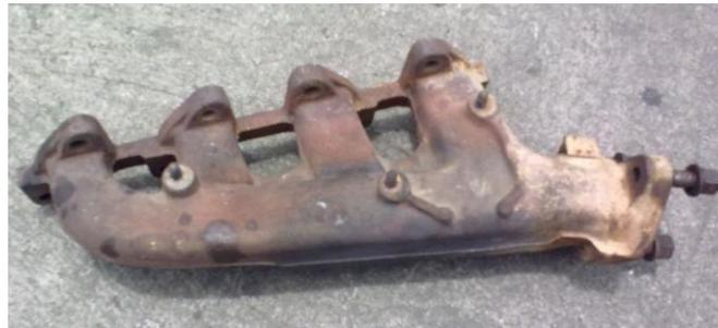
**Figura 2.38** Colector de escape
