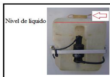
Figura 4.42: Depósito y bomba lavaparabrisas.
