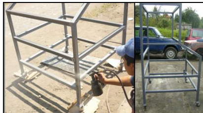
Figura 4.10: Pintado de la estructura.
