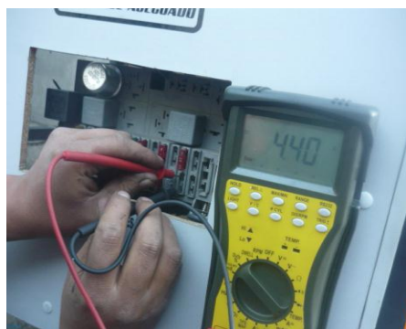
Figura 5.5: Comprobación de consumo de corriente.
