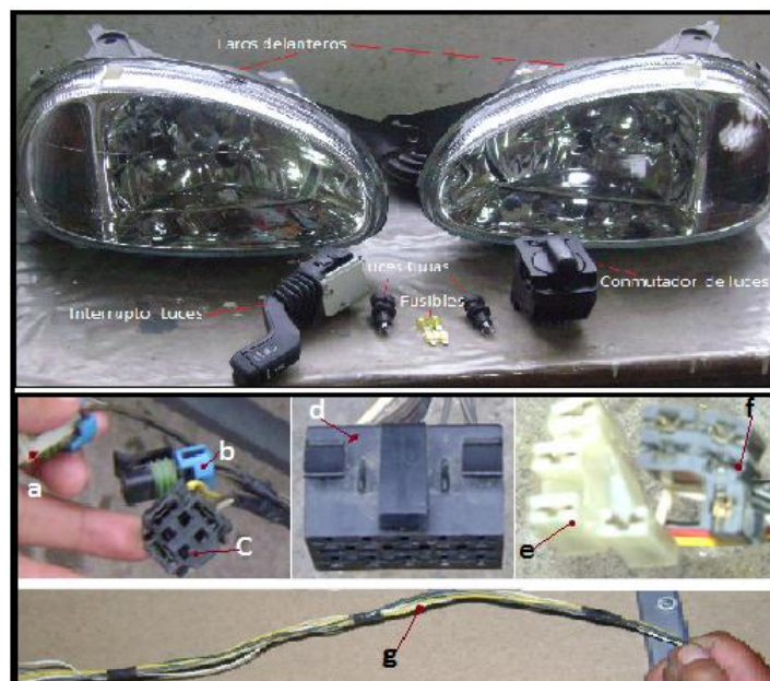
Figura 3.1: Elementos eléctricos del circuito de luces
