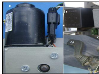
Figura 3.31: Elementos que conforman el circuito limpiaparabrisas.
