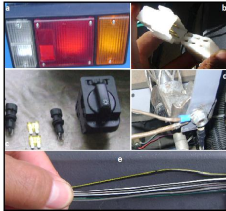
Figura 3.4: Elementos circuito luces guías.
