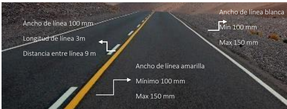
Figura 1-1. Medidas de señales horizontales blancas y amarillas sobre la calzada
