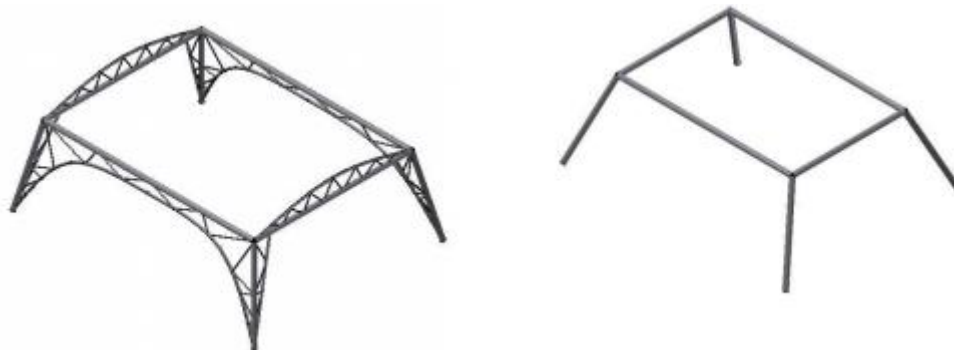
Figura 12-1: a) Estación Celosía. b) Estación tubular.
