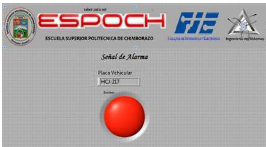
Figura IV. 57 Funcionamiento del sub VI Señal de Alarma
