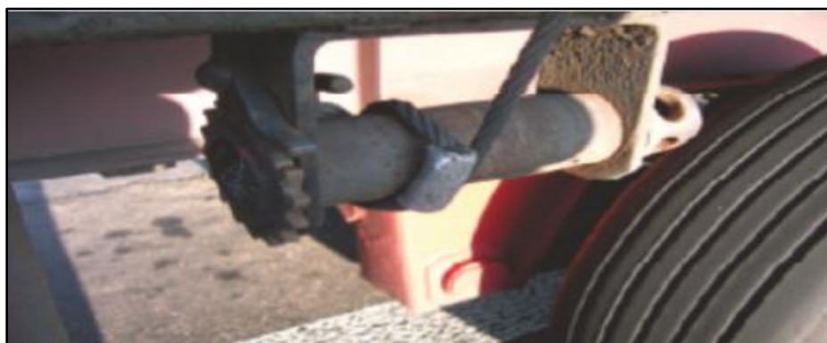
Figura 18-3. Cable de acero tensado a partir del torno fijo vehicular
