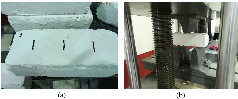
Figura 5-2: a) Señalización de probetas. b) Montaje ensayo de flexión en 3 puntos.
