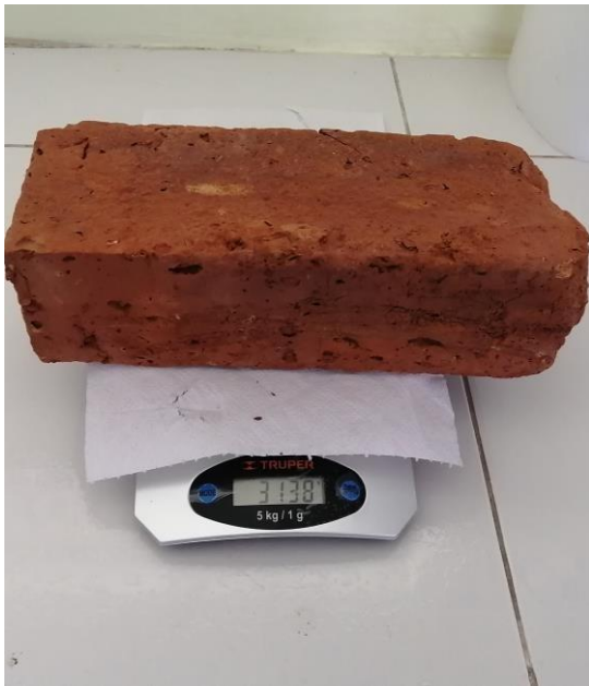
Fotografía 9. Pesaje de las probetas para determinar la porosidad
