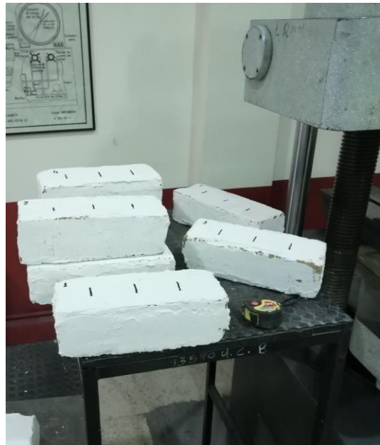
Fotografía 10. Preparación de las probetas para ensayos mecánicos
