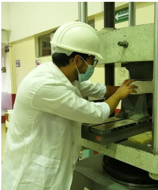
Fotografía 11. Ensayo de los ladrillos en la máquina universal
