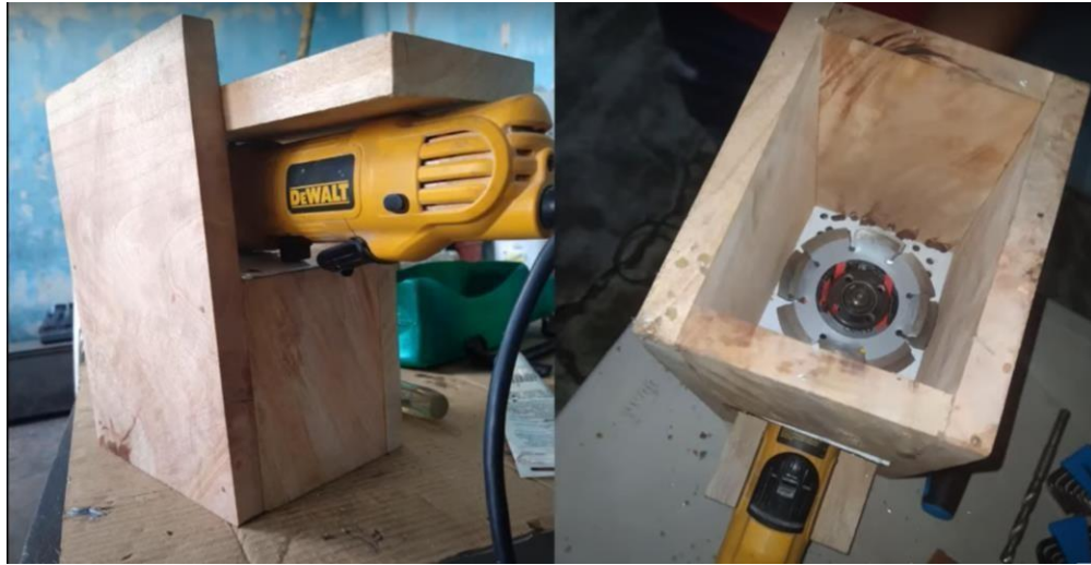
Figura 2-2: Trituradora casera de PET a base de una amoladora
