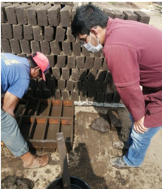
Fotografía 3. Prensado y conformación del ladrillo
