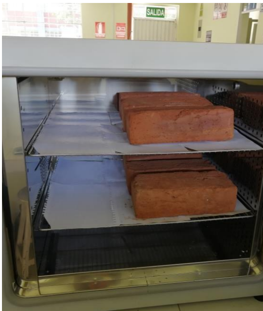
Fotografía 7. Estufa de secado para eliminar la humedad
