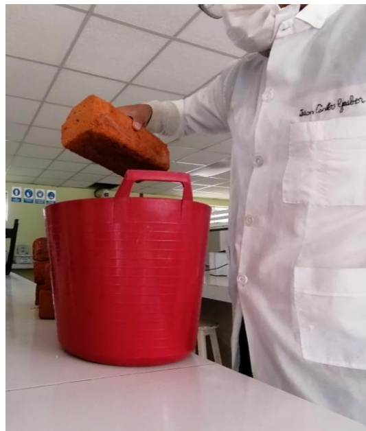
Fotografía 8. Sumergimiento de las probetas en agua destilada
