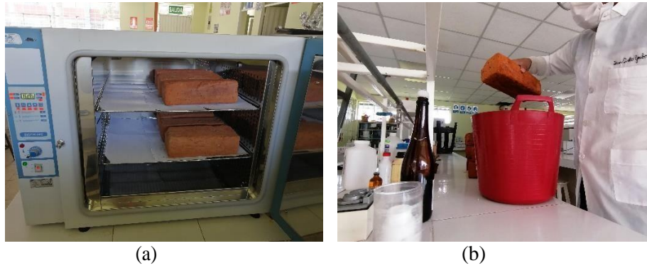
Figura 4-2: a) Horno de secado. b) Probetas sumergidas en agua destilada
