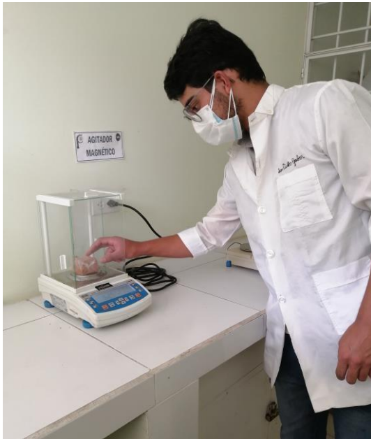
Fotografía 5. Pesaje de las probetas en la balanza analítica
