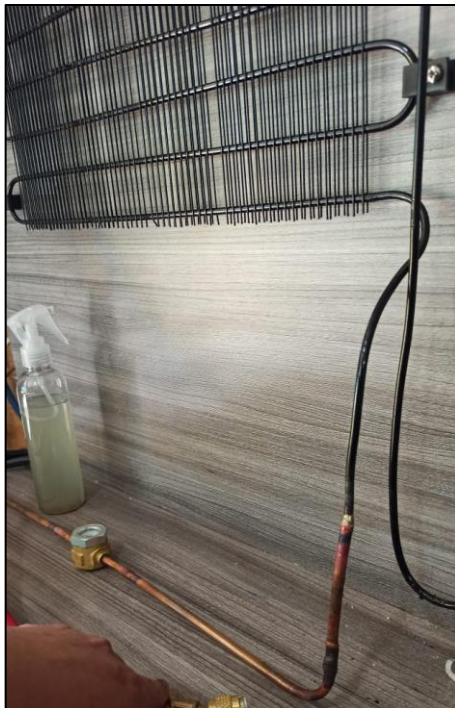
Figura 19-3: Conexión del condensador
