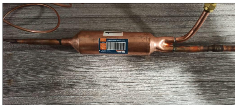
Figura 17-3: Conexión filtro de secado con tubería de \frac{1}{4}
