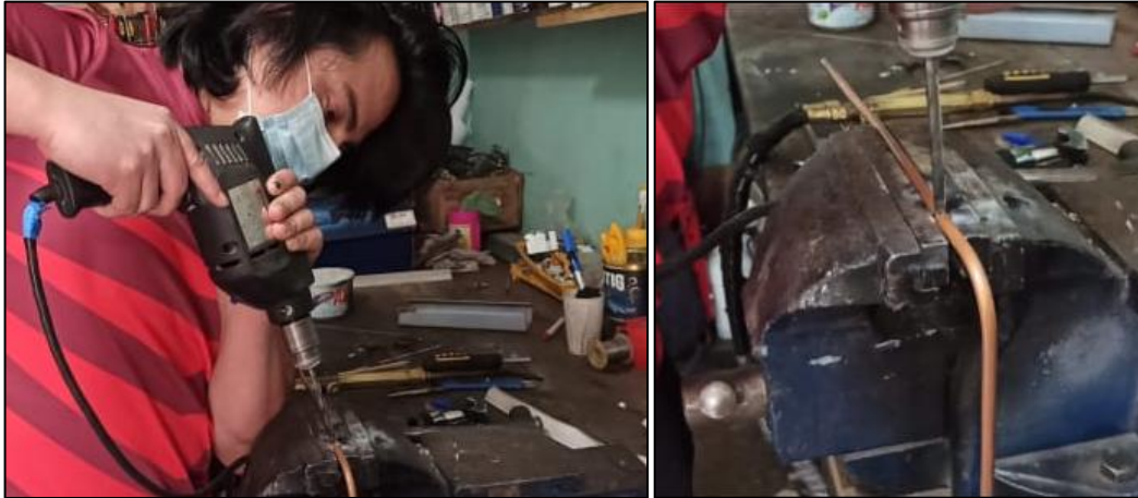
Figura 13-3: Conexiones T sobre cañería \frac{1}{4}
