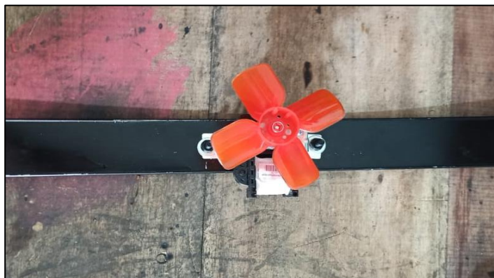
Figura 24-3: Ventilador sobre base de aluminio
