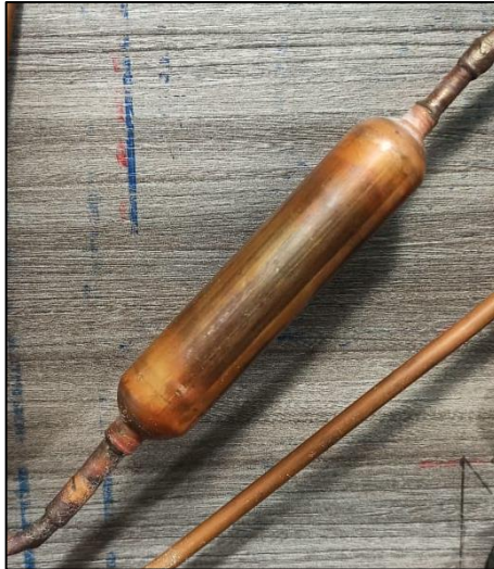
Figura 18-3: Conexión del acumulador
