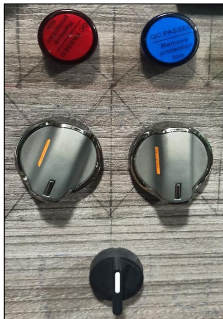
Figura 31-3: Instalación termostatos, selector de 3 posiciones
