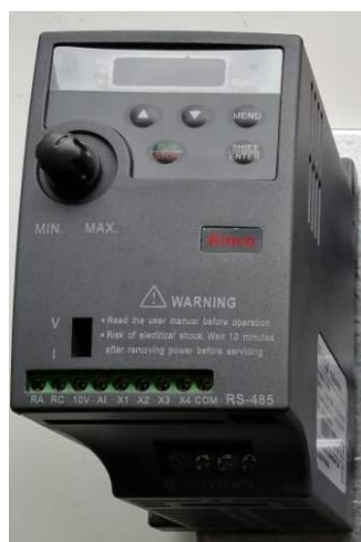
Figura 15-3: Variador de frecuencia Kinco CV20
