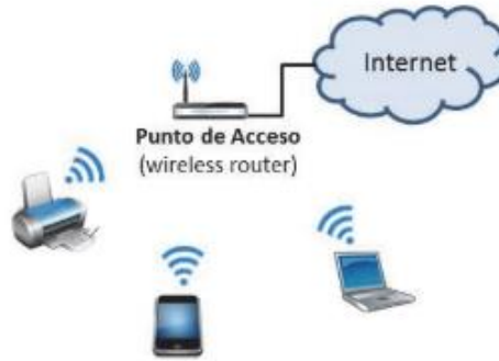
Figura 11-3: Esquema de una WLAN
