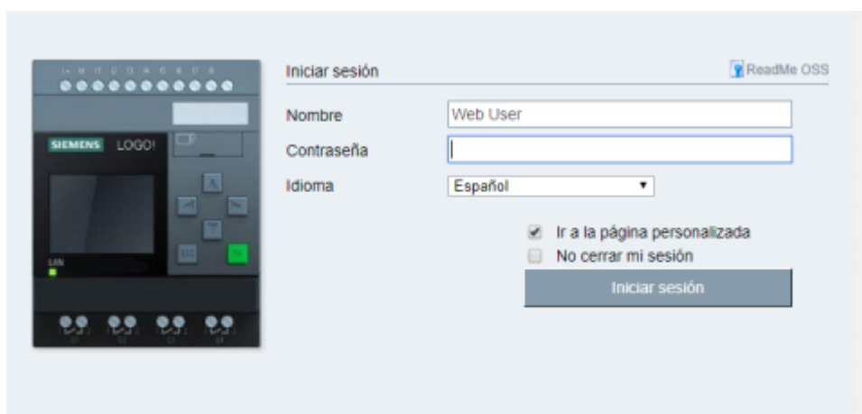
Figura 36-3: Ventana de ingreso a la Interfaz de mando remoto de servidor Web LOGO!
