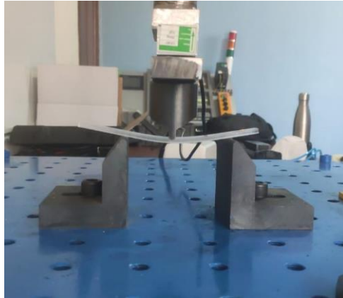
Figura 7-4: Ensayo de flexión pura
