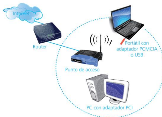
Figura 7-2: Como funciona un punto de acceso
