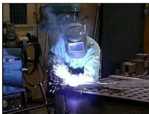
Figura 166-3: Arco de soldadura.
