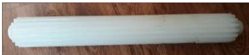
Figura 152-3: Eje conducido del sistema de dosificación construido.
