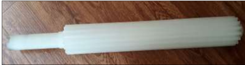
Figura 151-3: Eje conductor del sistema de dosificación construido.
