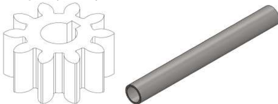
Figura 172-3: a) Esquema del piñón, b) Esquema del eje de la banda transportadora.
