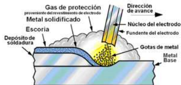
Figura 158-3: Partes de la soldadura SMAW.
