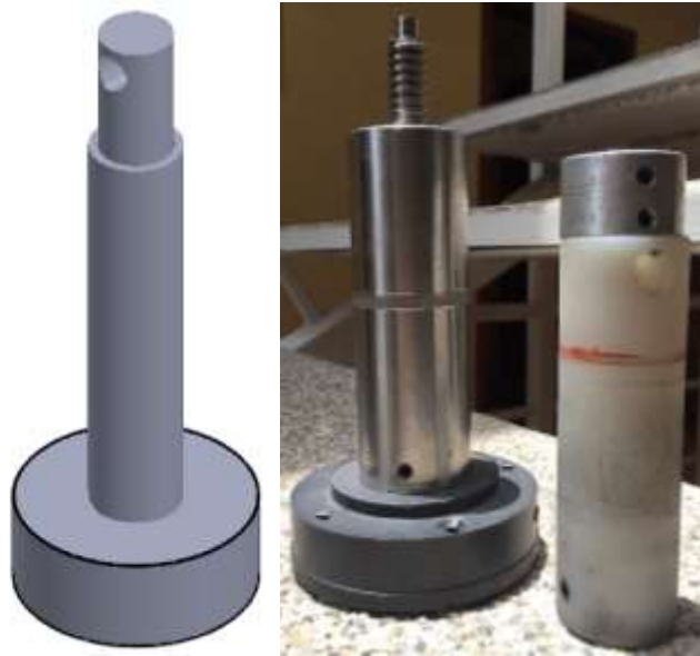
Figura 168-3: a) Esquema del sistema de elevación, b) Construcción del sistema de elevación.
