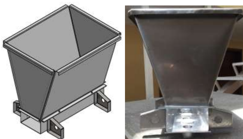
Figura 170-3: a) Esquema del sistema de inyección, b) Construcción del sistema de inyección.
