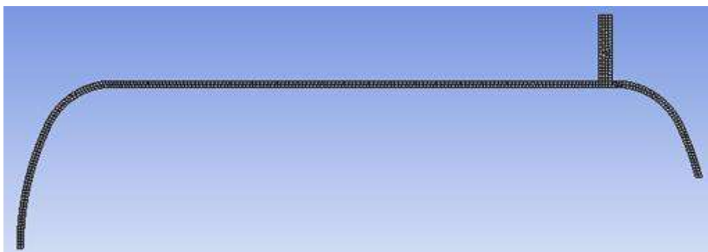
Figura 31-3. Mallado del reactor
