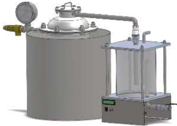
Figura 10-3. Diseño conceptual - reactor de pirólisis
