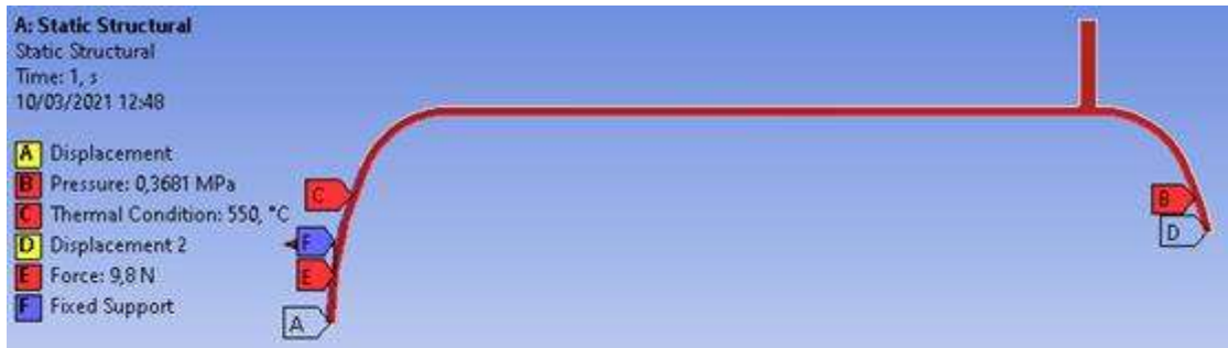
Gráfico 1-3. Asignación de parámetros estructurales en el reactor
