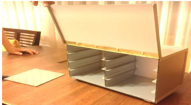
Figura 7-2. Caja para recibir muestras, con placas de acero para el depósito de la fuente radiactiva.
