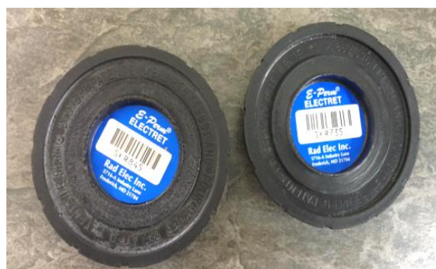
Figura 8-2. Electretes usados en nuestro experimento.
