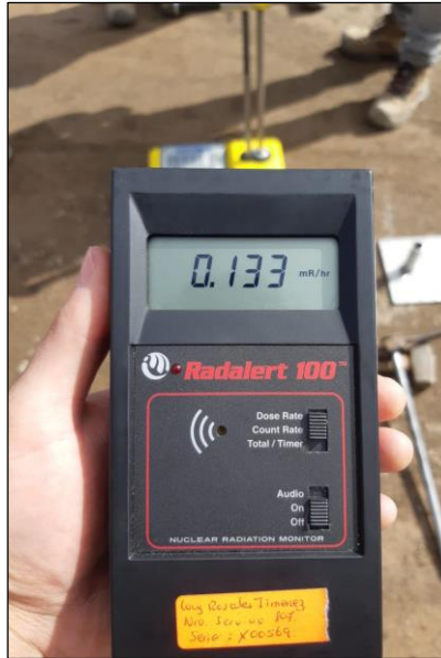
Figura 6-1. Contador Geiger Müller modelo Radalert 100 midiendo la tasa de dosis equivalente del Densímetro Nuclear
