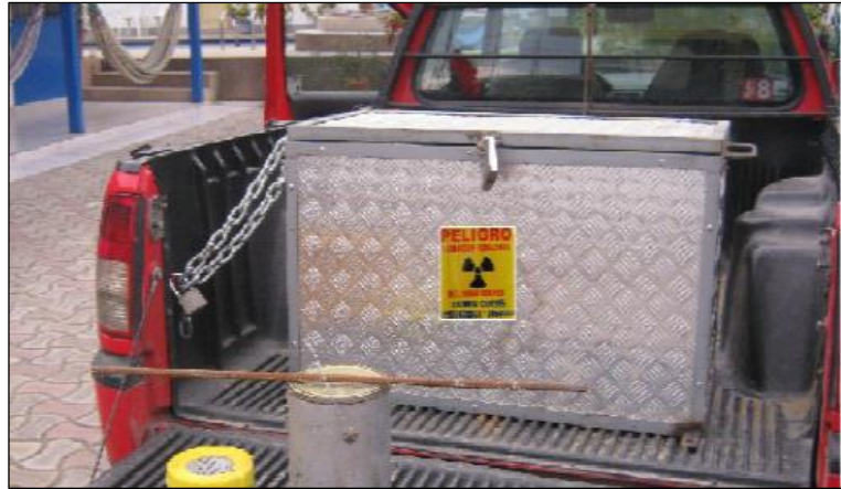
Figura 5-3: Densímetro nuclear dentro de la caja metálica en el balde de la camioneta
