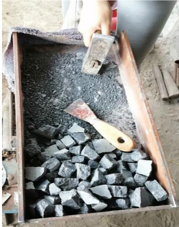
Figura 2-2: Proceso de trituración y pulverización de las muestras de granito.
