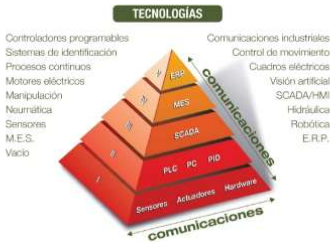
Figura 9-2: Pirámide de automatización.
