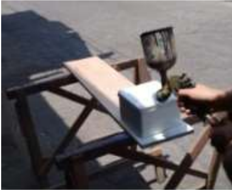
Figura 19-3: Proceso de pintura de la caja del sistema
