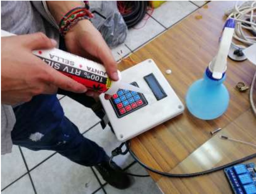
Figura 17-3: Aseguramiento de los componentes con silicón en el sistema
