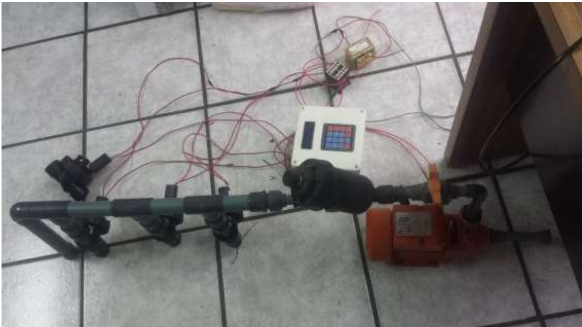
Figura 30-3: Sistema de riego y control completo
