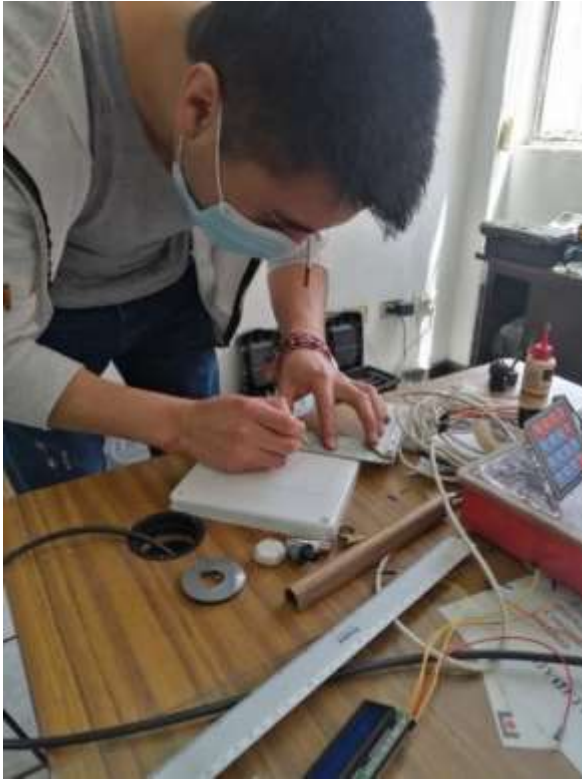
Figura 13-3: Medición para la instalación respectiva del LCD del sistema
