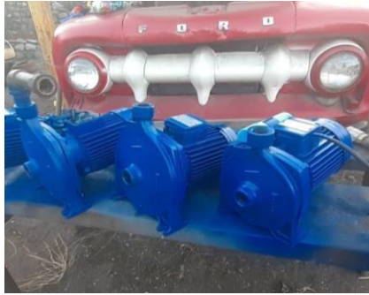
Figura 6-3. Conjunto motor bomba.
