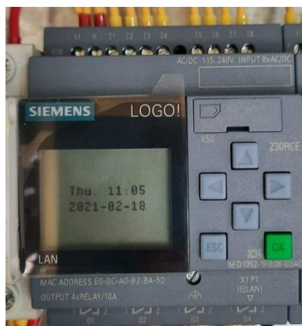
Figura 21-3. Modulo Programable Logo Siemens V8.
