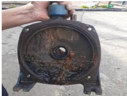
Figura 3-3. Partículas adheridas a las paredes de bombas.
