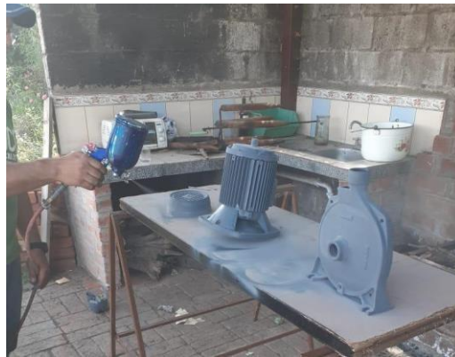
Figura 5-3. Reacondicionamiento de la superficie externa.
