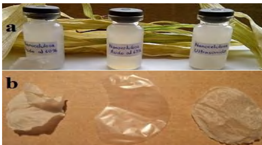
Figura 6-3. Imagen de: (a) suspensiones de nanocelulosa, (b) láminas de nanocelulosa.
