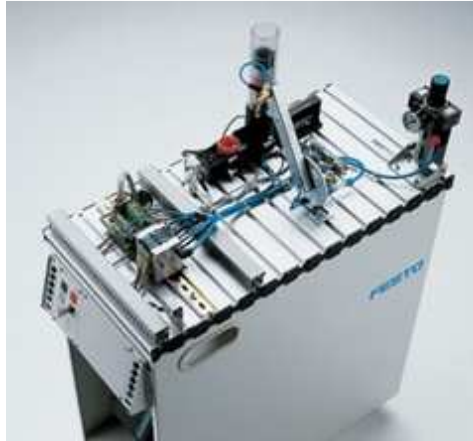
Figura V - 118 Estación de Distribución
