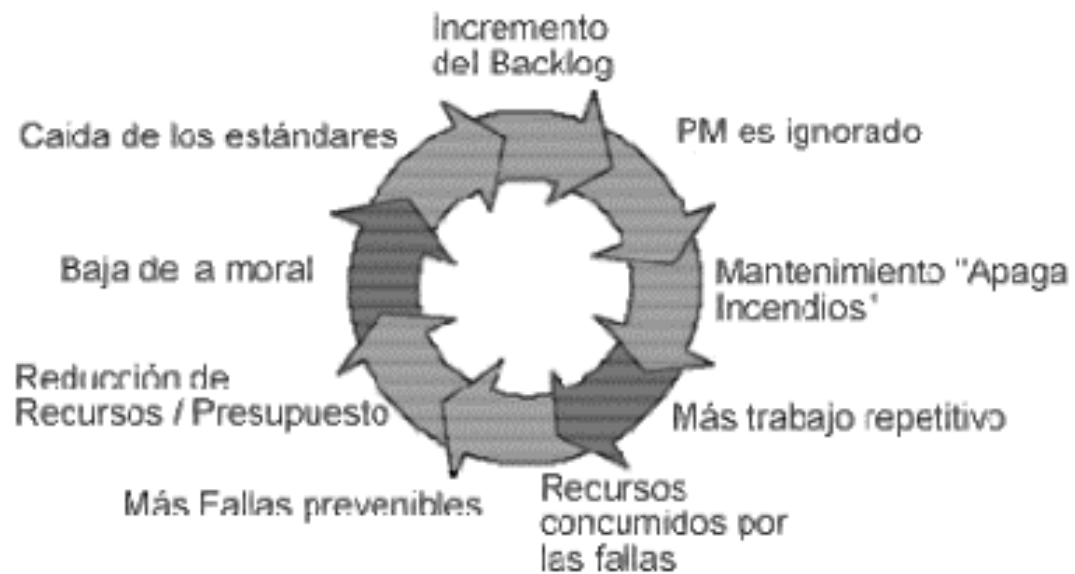
Figura 2-2: Círculo vicioso del mantenimiento. Fuente: (Turner, 2009)
