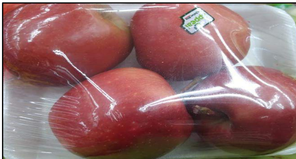
Figura 6-3: Prototipo del bioplástico de quinua utilizado como envoltura para alimentos.
