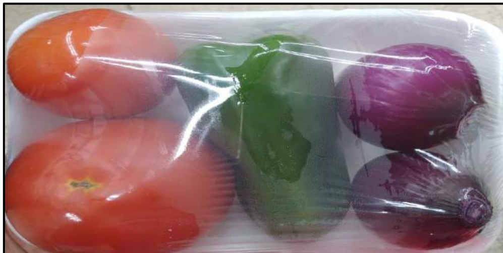
Figura 5-3: Prototipo del bioplástico de maíz utilizado como envoltura para alimentos.
