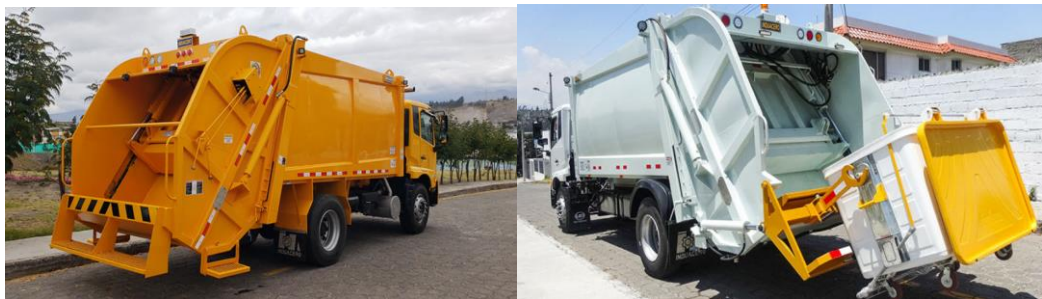
Figura 4-2: Cajas compactadoras fabricadas en INDUACERO CÍA. LTDA.
