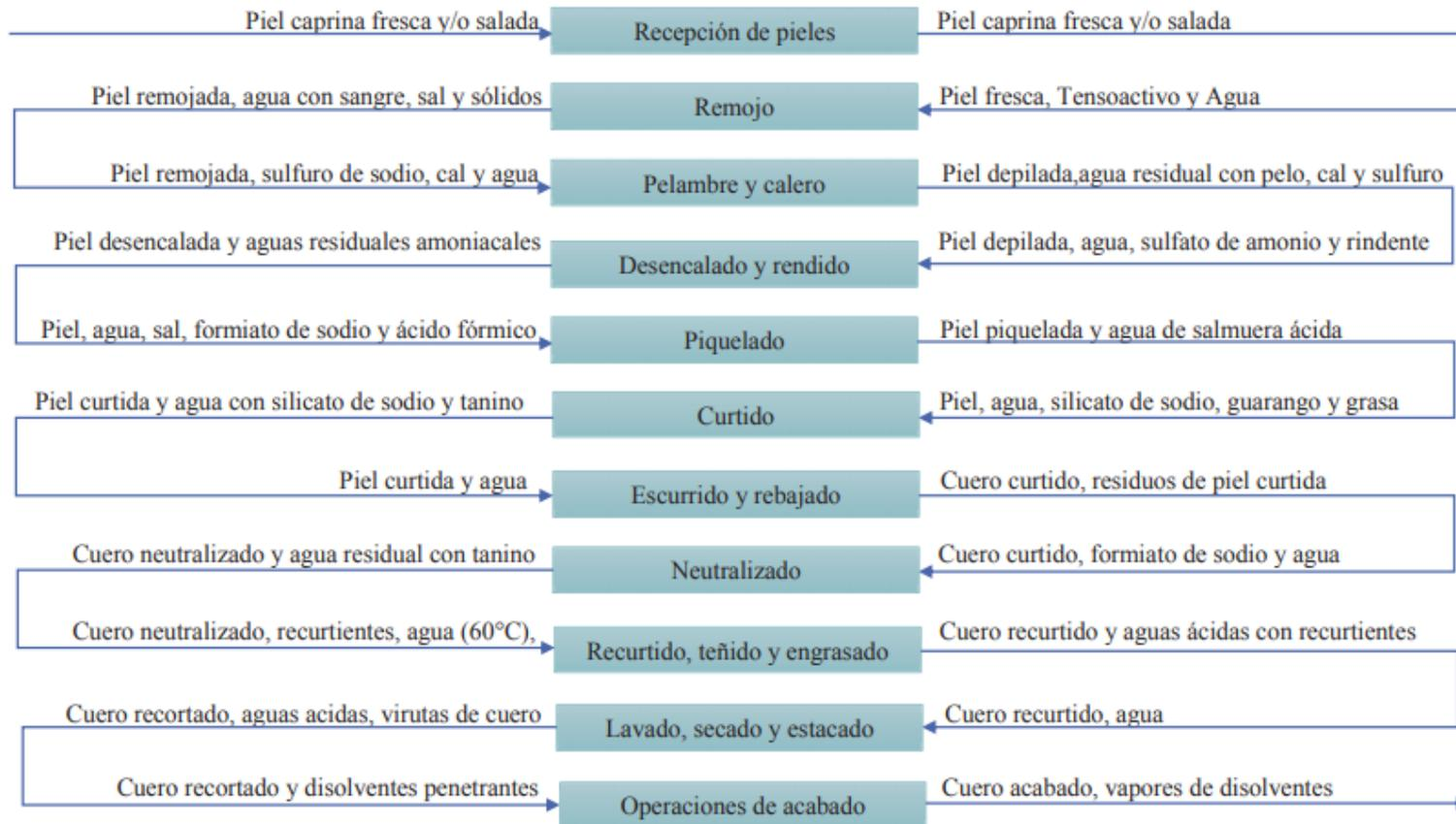
**Figura 2-1:** Diagrama del proceso
