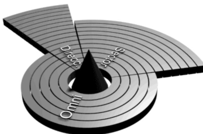
Figura III.6. Tipos de Antenas
