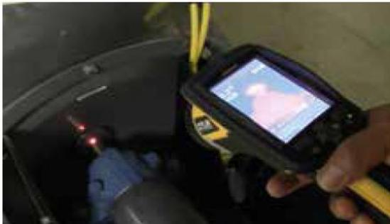
**Figura 6-2.-Inspección de un componente mecánico mediante termografía.**
