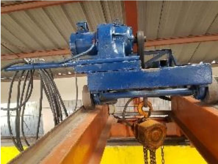
**Figura 5-3.-** Componentes mecánicos del movimiento horizontal.
