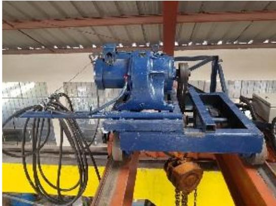
**Figura 19-3.-** Motor-reductor del carro horizontal
