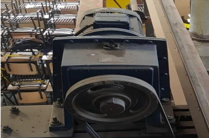
**Figura 22-3.-** Motor-reductor del movimiento transversal.
