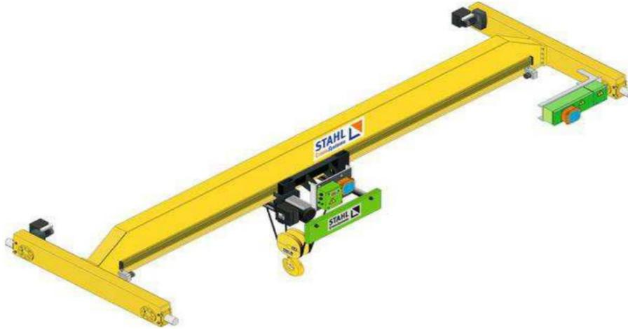
**Figura 3-2.-** Puente grúa de mono viga.
