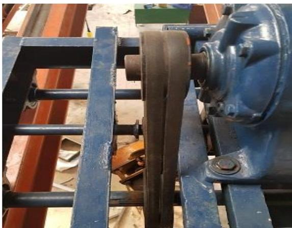
**Figura 31-3.-** Sistema de transmisión del carro de movimiento horizontal
