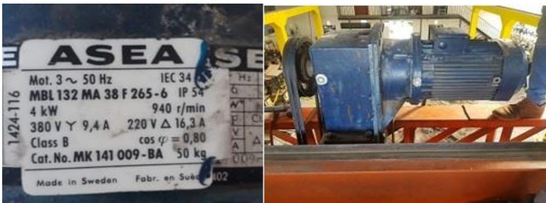
**Figura 6-3.-**Características del motor-reductor del movimiento transversal
