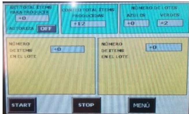
Figura 66-3: Contador total en la pantalla HMI.
