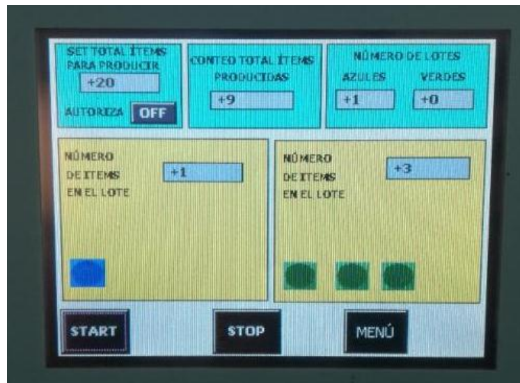
Figura 63-3: Sistema de transporte de bandas en HMI
