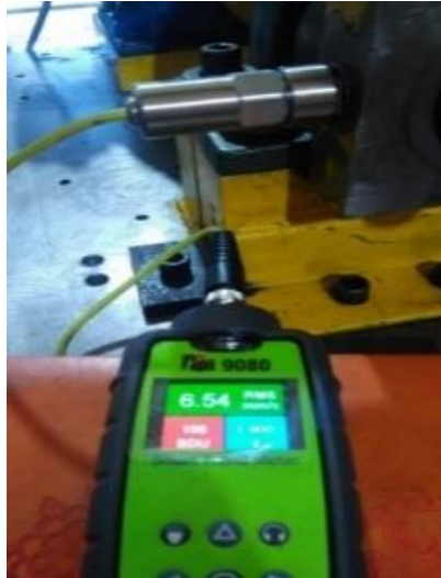
Figura 14-3: Colocación en el punto de medición Fuente: PCE.
