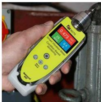
Figura 10-3: Medidor de vibraciones TPI 9070 Fuente: PCE.
