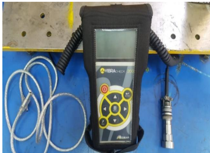
Figura 3-3: Analizador de vibraciones Vibracheck 200 Fuente: Autores
