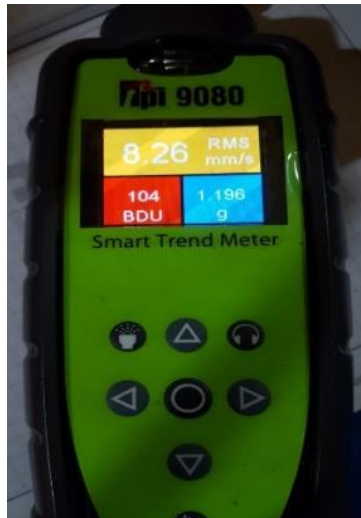
Figura 16-3: Valores de falla de BDU Fuente: PCE.
