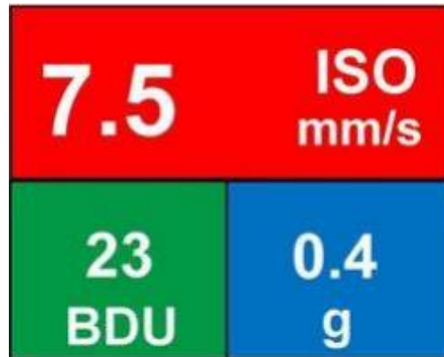
Figura 11-3: Pantalla del medidor de vibraciones TPI 9070
