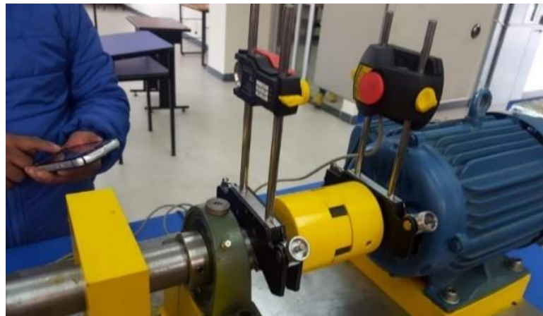
Figura 18-2: Alineación del motor y chumaceras Fuente: Autores
