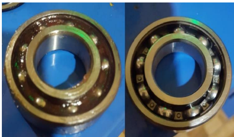
Figura 9-3: Condiciones de lubricación defectuosa Fuente: Autores.
