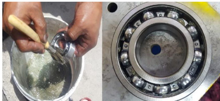
Figura 8-3: Limpieza del rodamiento Fuente: Autores.
