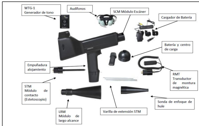
Figura 2-3: Accesorios del equipo ULTRAPROBE 15000 Fuente: UE System Inc.
