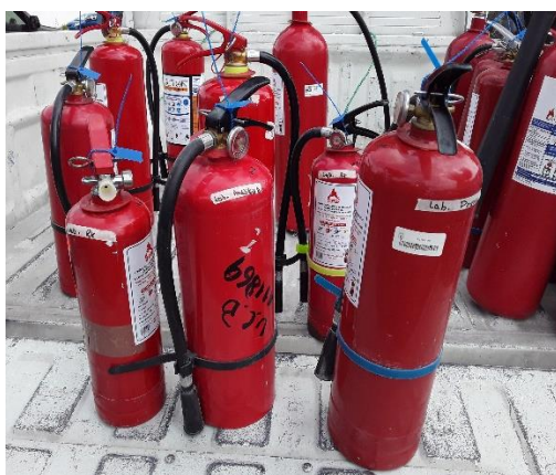
Figura 6-4: Extintores portátiles recargados Realizado por: Ayuquina Laguna, Miryam, 2020
