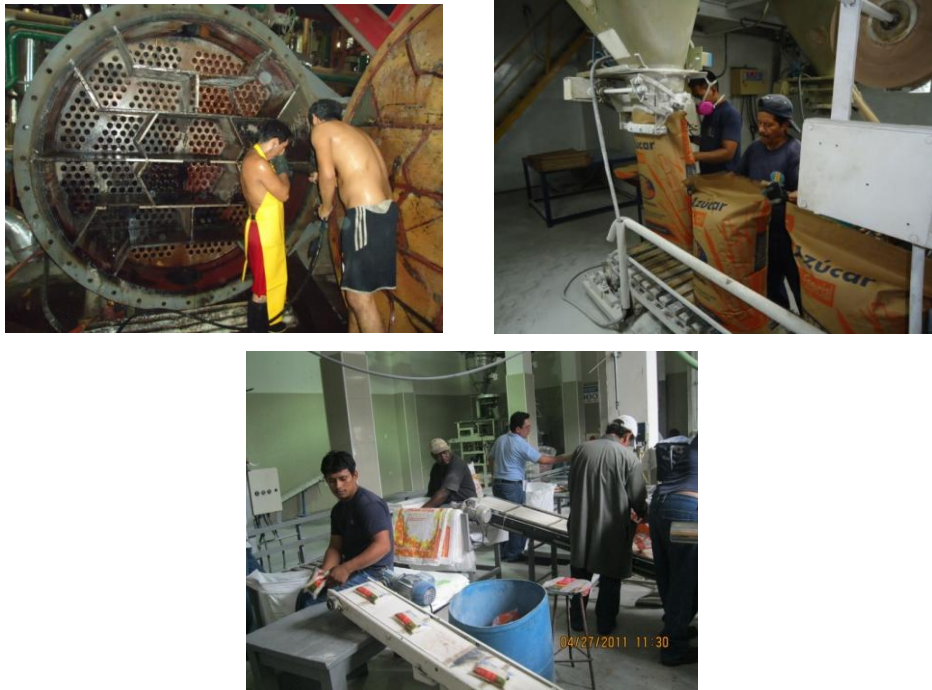
Figura 80: Falta de la utilización de equipo de protección personal
