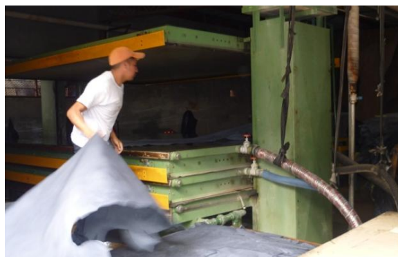
Figura 3.5.2 (a): Operación de Vacío. Fuente: Empresa "Curtiduría Tungurahua S.A.".
