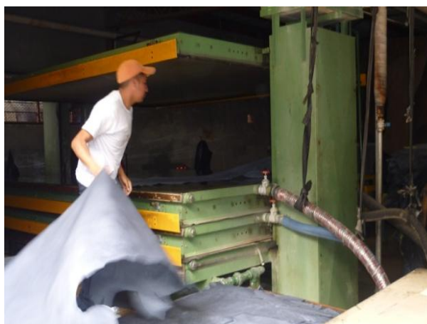
Figura 3.3.2 14(a): Secado de las Pieles. Fuente: Em presa “Curtiduría Tungurahua S.A.”.
