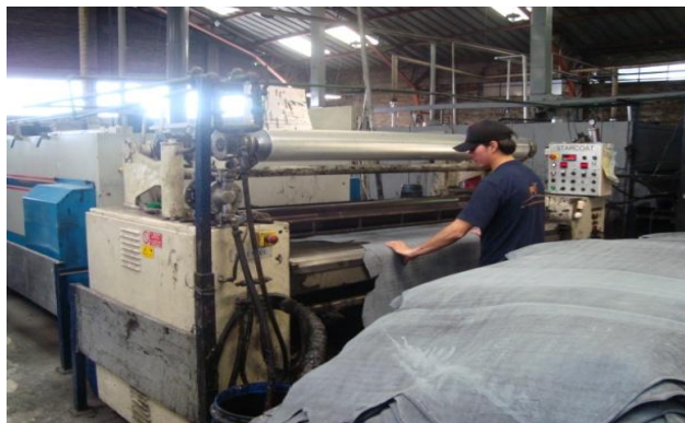
Figura 3.5.2 (c): Operación en Roller. Fuente: Empresa “Curtiduría Tungurahua S.A.”.
