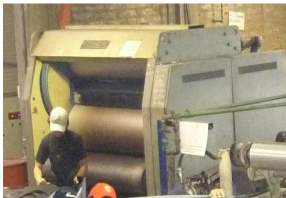
Figura 3.5.2 (d): Operación en Plancha Continua. Fuente: Empresa “Curtiduría Tungurahua S.A.”.
