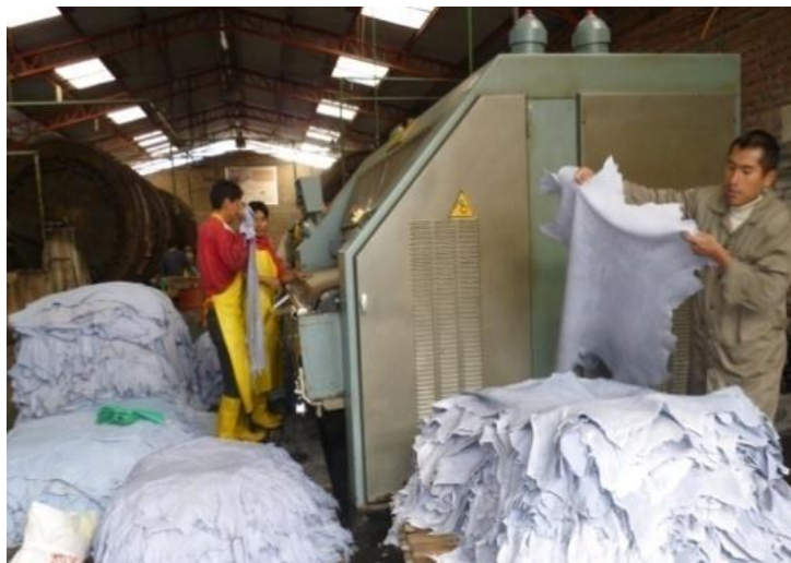
Figura 3.3.2 9(a): Ecurrido de las Pielés. Fuente: Empresa “Curtiduría Tungurahua S.A.”.
