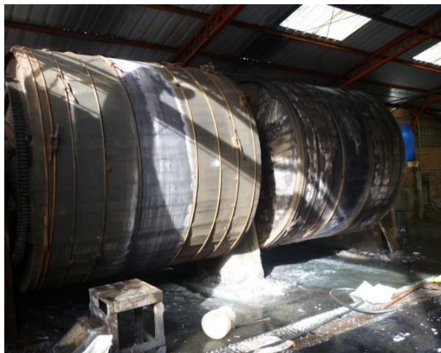
Figura 3.3.2 6(a): Descalcado y Purga de las Pielas.
