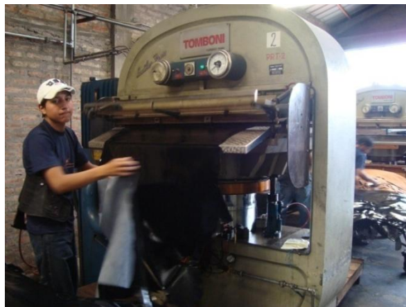
Figura 3.5.2 (e): Operación en Plancha Hidráulica. Fuente: Empresa "Curtiduría Tungurahua S.A.".
