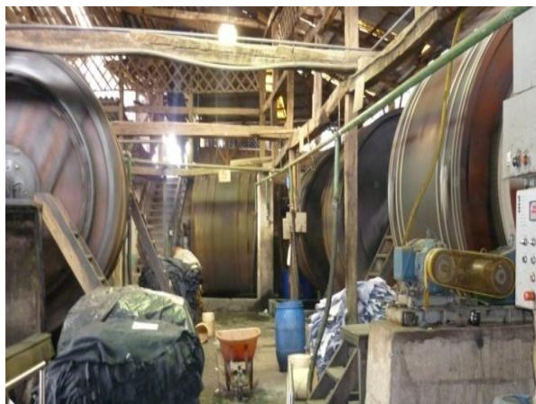
Figura 3.3.2 11(a): Recurtido de las Pielés. Fuente: Em presa “Curtiduría Tungurahua S.A.”.
