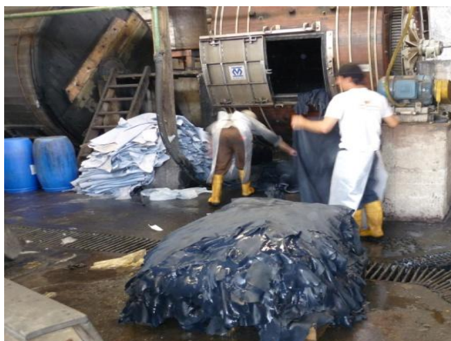
Figura 3.3.2 12(a): Teñido y Engrase de las Pielés. Fuente: Em presa “Curtiduría Tungurahua S.A.”.
