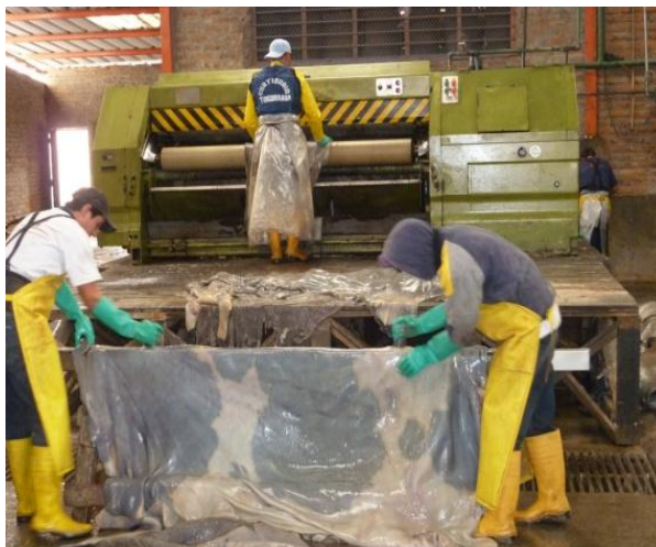
Figura 3.3.2 3(a): Descarnado de las Pielés. Fuente: Em presa “Curtiduría Tungurahua S.A.”.
