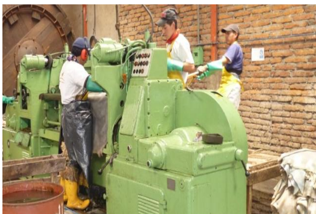
Figura 3.3.2 4(a): Depilado de las Pielés. Fuente: Em presa “Curtiduría Tungurahua S.A.”
