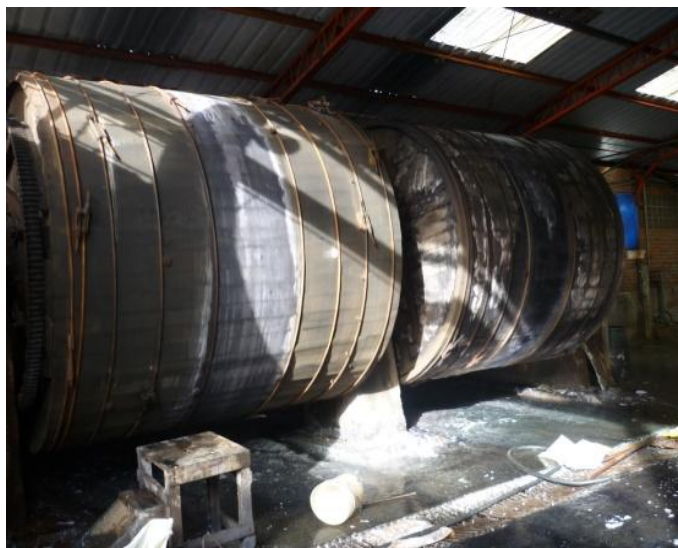
Figura 3.3.2 8(a): Piquelado y Curtido de las Pielas. Fuente: Empresa "Curtiduría Tungurahua S.A."
