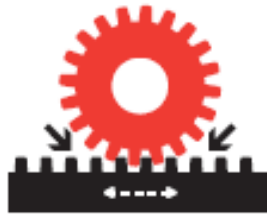
Figura 23: Partes giratorias y otras con desplazamiento tangencial a ellas.
