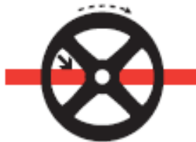
Figura 24: Entre piezas giratorias y partes fijas.
