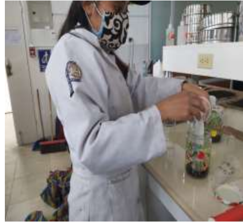
Colocación de Suelo en los frascos
