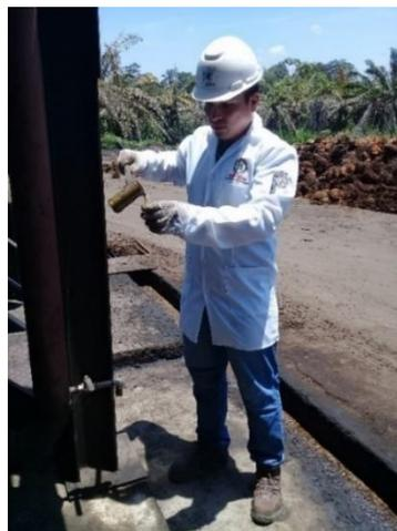
**ANEXO N:** MEDICIÓN DE LA TEMPERATURA AL LICOR DE PRENSA ANTES DEL INGRESO AL TRICANTER
