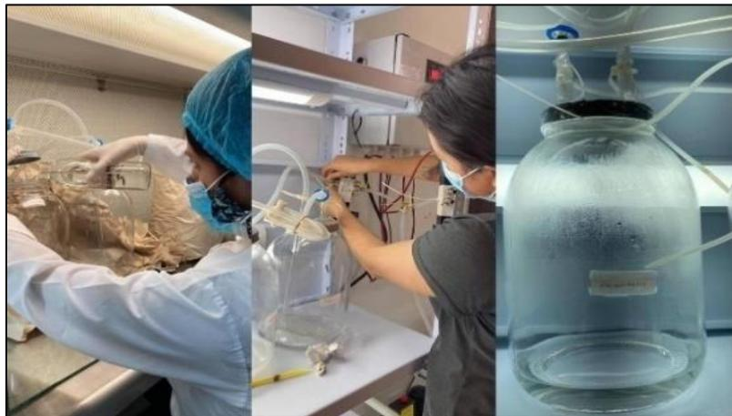
**Figura 11-2:** Pruebas de contaminación en los biorreactores gemelos
