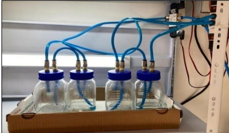
**Figura 6-2:** Biorreactores del SIT conectados a las electroválvulas
