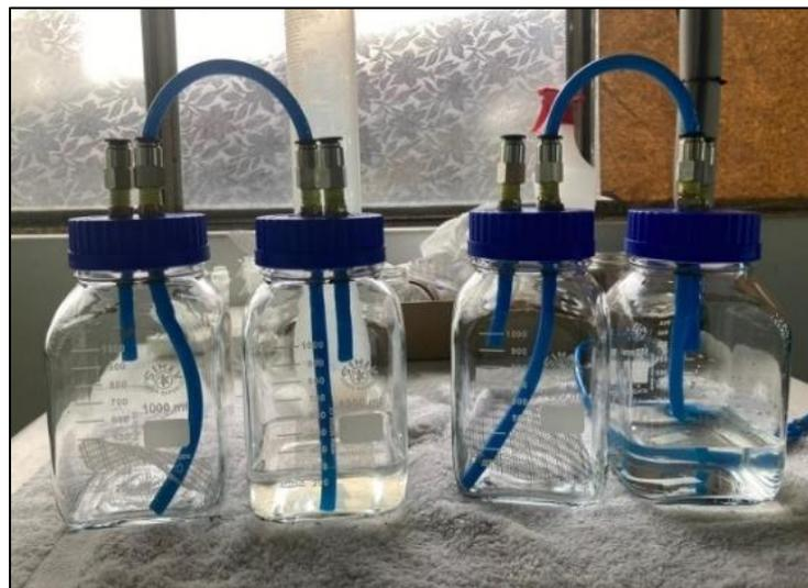
**Figura 5-2:** Biorreactores del Sistema de Inmersión Temporal
